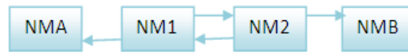
Figura 28. NM1 y NM2 necesitan cooperar entre ellos para llevar información a su destino
