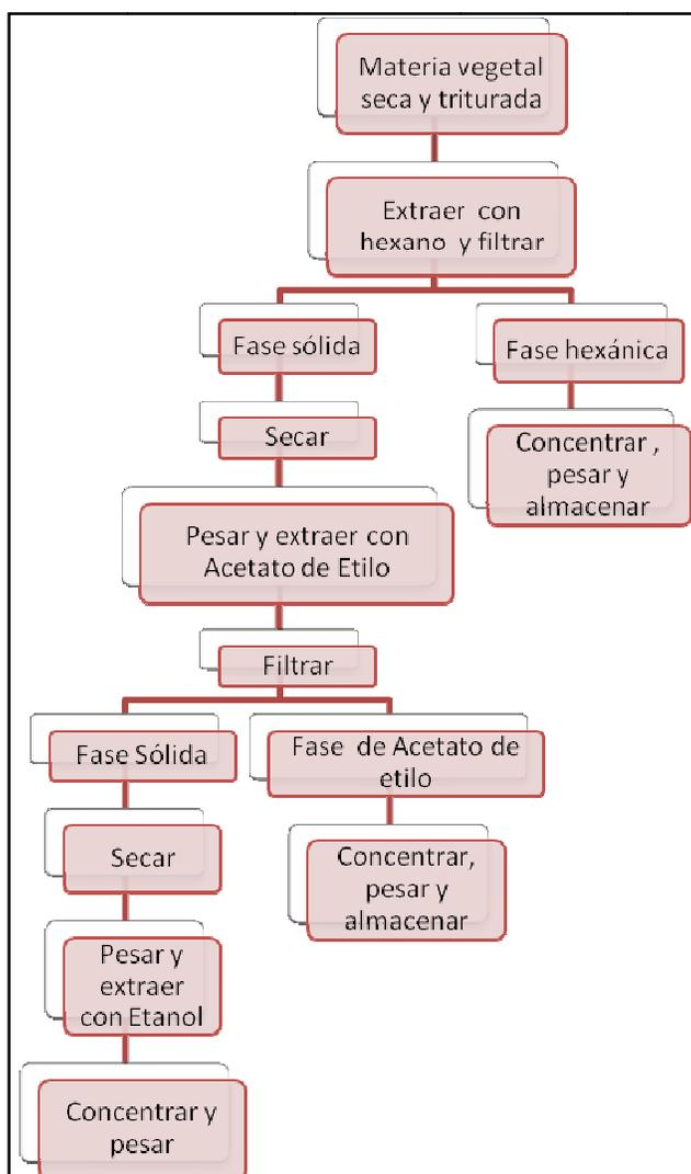
Esquema N°5 Proceso de Extracción
