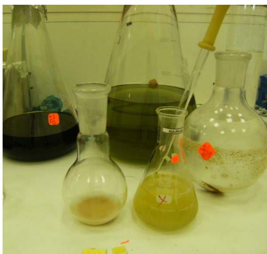
Figura N°19 Separación del precipitado con una pipeta Pasteur.
