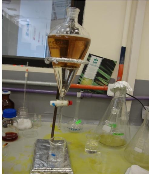
Figura N°20 Extracción líquido-líquido (Fase acuosa parte superior y Fase Orgánica inferior).
