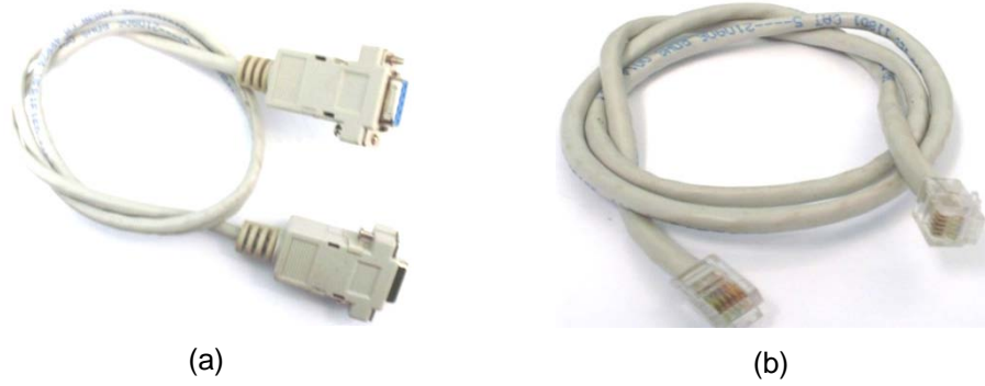
Fig. 3. 14: Cables de conexión de señales de control entre la interfaz y equipos
