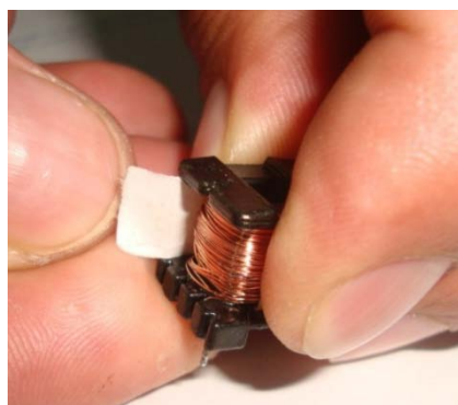
Fig. A.1. 4: Colocación del material dieléctrico
