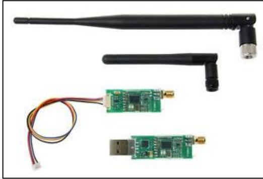
Figura 3.18. Módulos de telemetría HKPilot 915 MHz.
