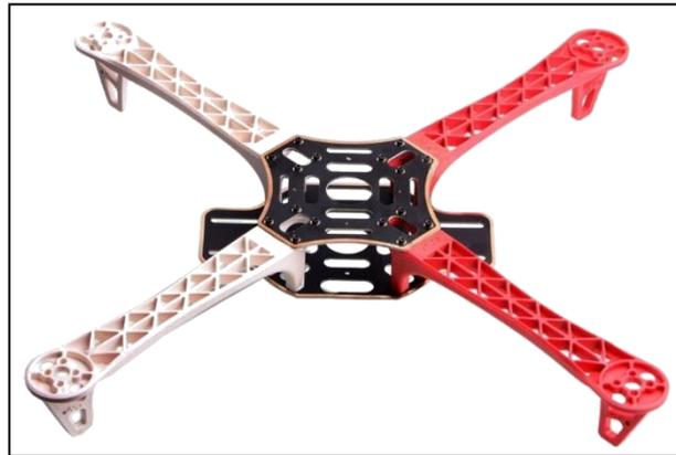
Figura 3.11. Estructura del VANT F450 mm.
