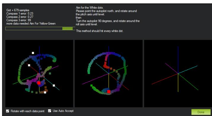
Figura 3.27. Ventana de calibración de la Brújula.
