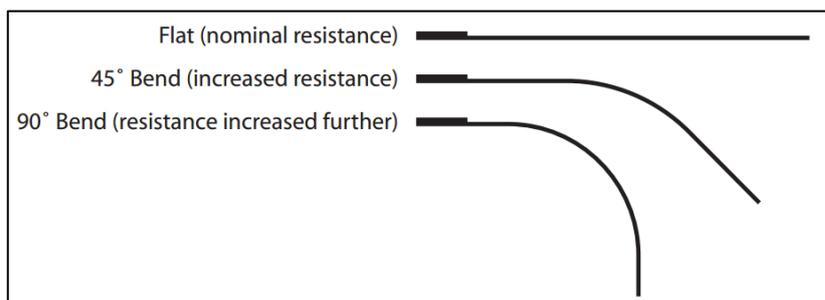
Figura 3.9. Estados del sensor flexo-resistivo.
