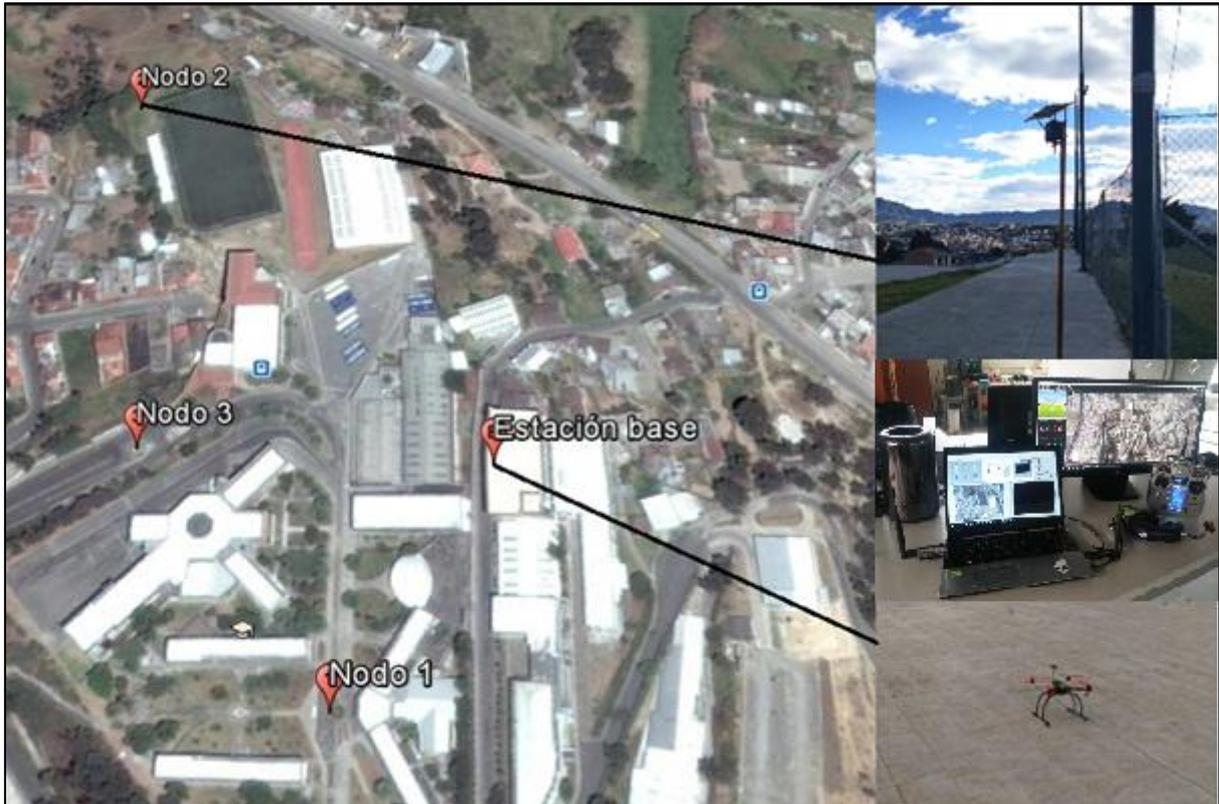
Figura 4.4. Ubicación de la estación base y de los nodos que componen la WSN.
