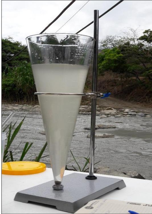
**Figura 55:** Ensayo de calidad de agua por contenido de sólidos, Convergencia de los ríos Calera y Amarillo.
