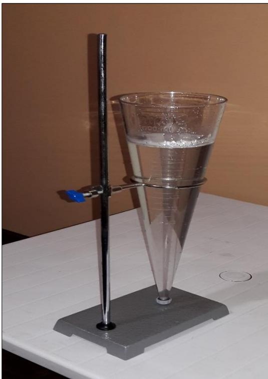
**Figura 53:** Ensayo de calidad de agua por contenido de sólidos, río Amarillo.
