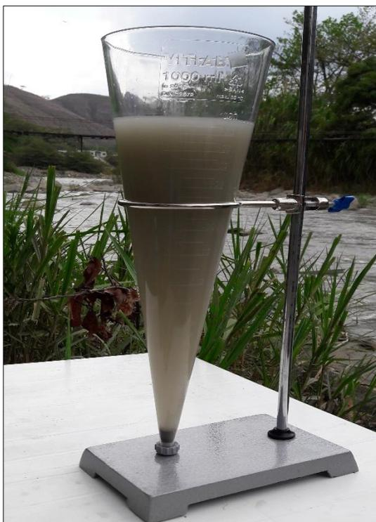
**Figura 54:** Ensayo de calidad de agua por contenido de sólidos, río Calera.
