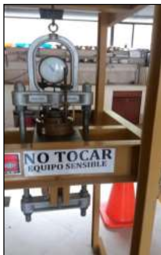
Figura 25. Ensayo de consolidación. Fuente: Autor. Elaboración: Autor.
