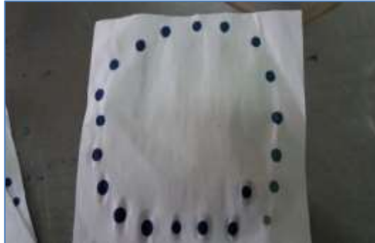
Figura 24. Ensayo de azul de metileno. Fuente: Autor. Elaboración: Autor.
