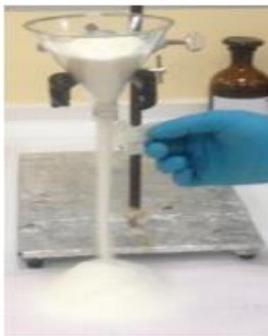
**Figura 2.** Determinación del tiempo de deslizamiento.
