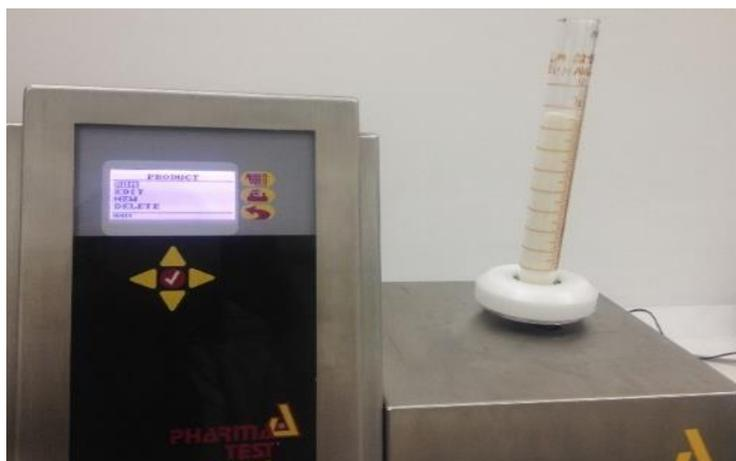
**Figura 4.** Determinación de la densidad compactada por medio del equipo “tap density tester” modelo PT-DT200
