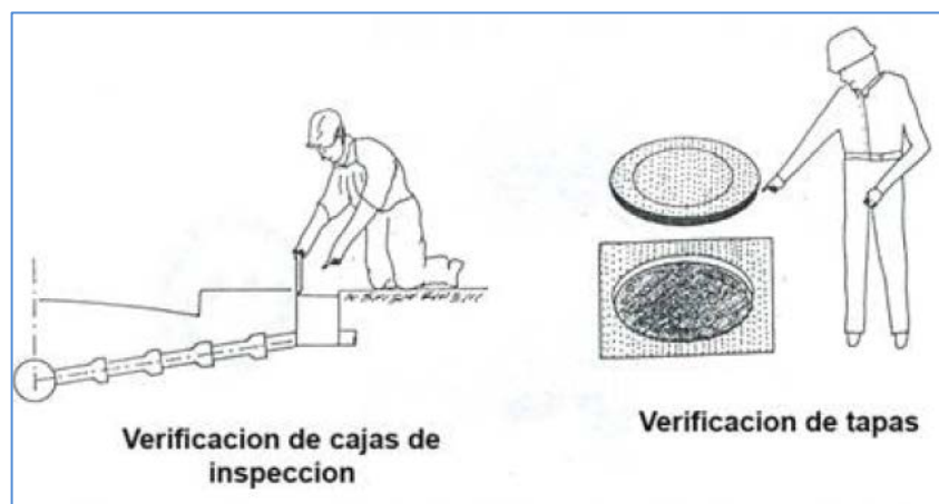
Figura 6.4 Verificación de cajas de los registros domiciliarios y de las tapas.
