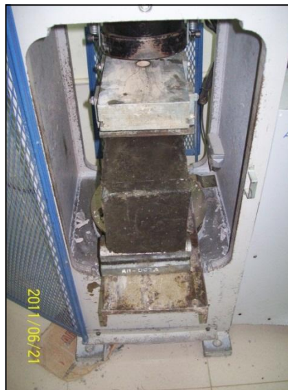
Figura 3.5.1_2. Montaje de la viga en la máquina de prueba Fuente: El Autor
