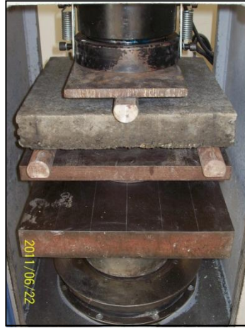
Figura 3.5.3_1. Montaje de las losas en la máquina de prueba. Fuente: El Autor
