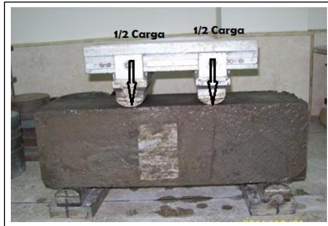
Figura 3.5.1_1. Sistema de carga empleado en vigas Fuente: El Autor
