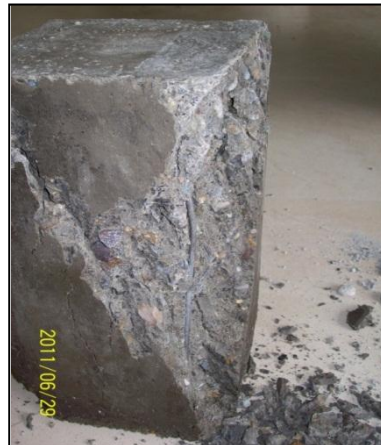
Figura 4.3.2_2. Pandeo de las barras longitudinales en elementos con recubrimientos apropiados. Fuente: El Autor.
