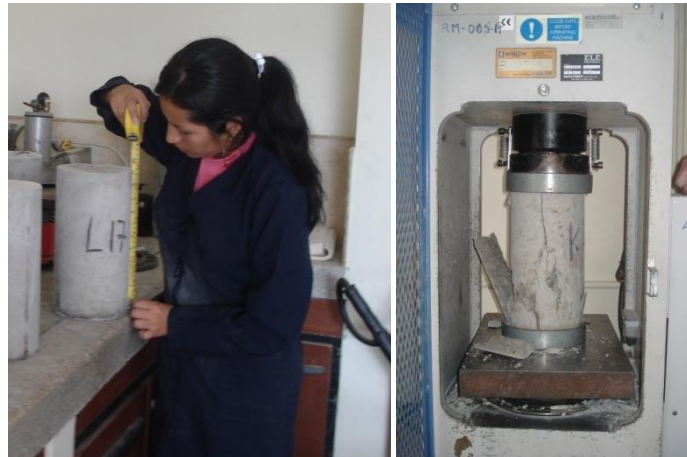
Fotografía 8. Ensayo de Resistencia: a) Medición de cilindros b) Ruptura de cilindros. Fuente: La Autora
