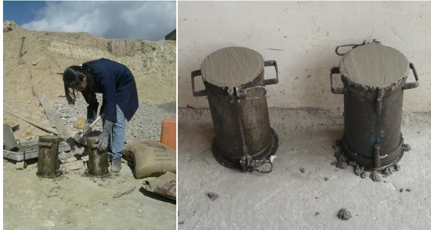
Fotografía 6. Realización de probetas cilíndricas Fuente: La Autora
