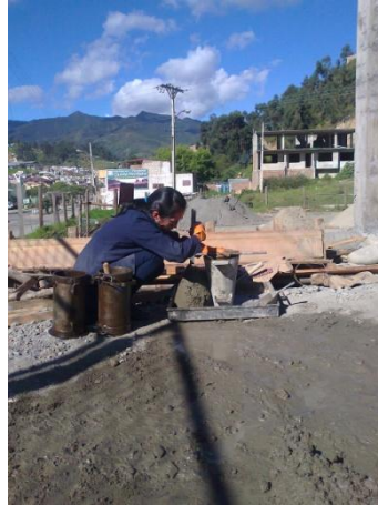
Fotografía 5. Ensayo de asentamiento Fuente: La Autora
