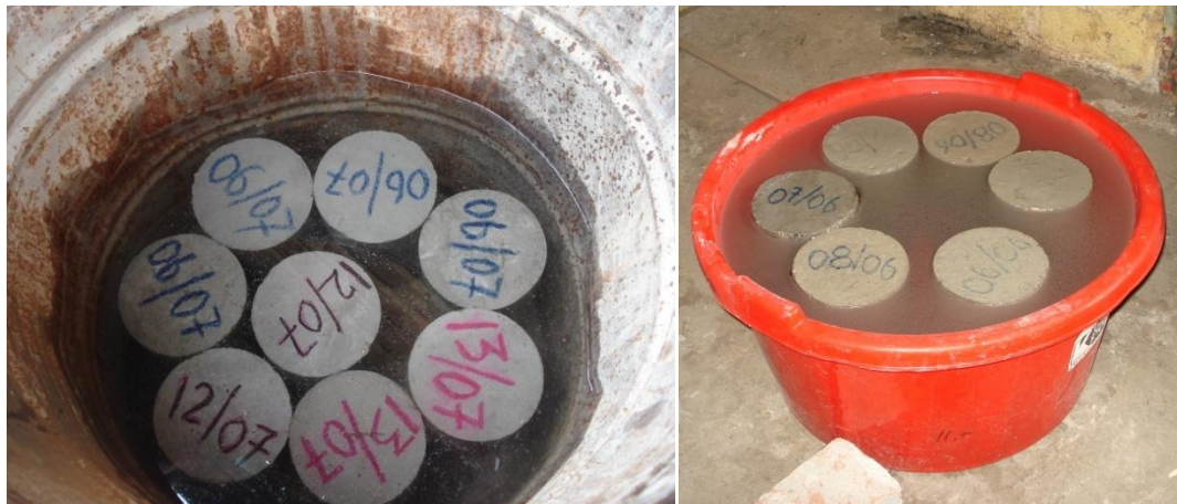
Fotografía 7. Curado de probetas cilíndricas Fuente: La Autora
