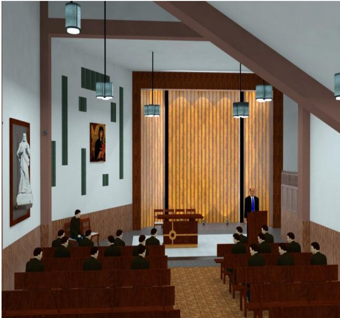
Fig. 3.6. Acentuación del altar con luz de tono blanco cálido e iluminación directa, en un escenario nocturno. Elaborado por los autores
