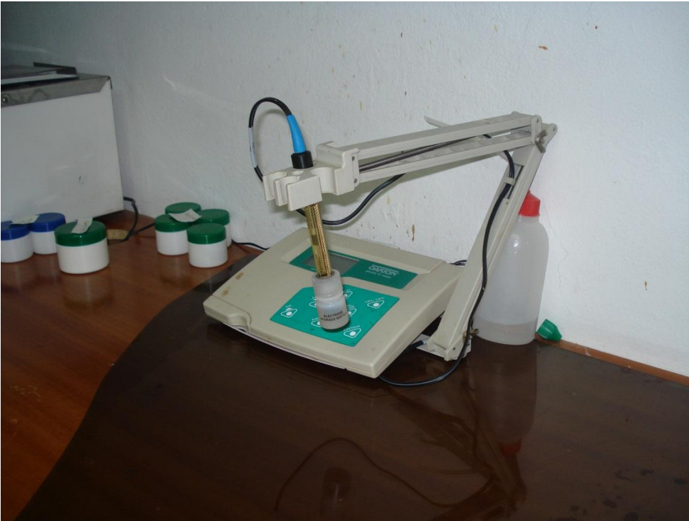
Control de calidad (equipo potenciómetro para medir el pH)
