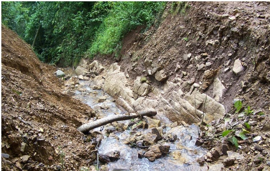
Foto 1. Rocas volcánicas diaclasadas, la potencia de la sobrecarga es de 1m.
