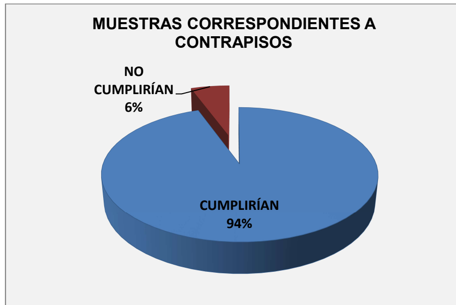
Gráfica 4.8: Resistencia estimada a los 28 días en muestras correspondientes a contra pisos.
