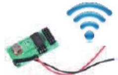
**Transmisor inalámbrico Smartfloor:** Incrustado en cada módulo Smartfloor, este transmisor es capaz de enviar datos a una distancia de 50 metros. El dispositivo se puede programar con sensores para detectar peso, niveles de iluminación, niveles de CO2 y más. Cada sensor es alimentado por la baldosa SmartFloor lo que elimina la necesidad de baterías o cables.
