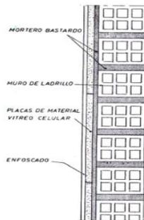
Fig. 2.18. Aislamiento de una pared de fachada con vidrio celular decorativo. Fuente: Payá M.
