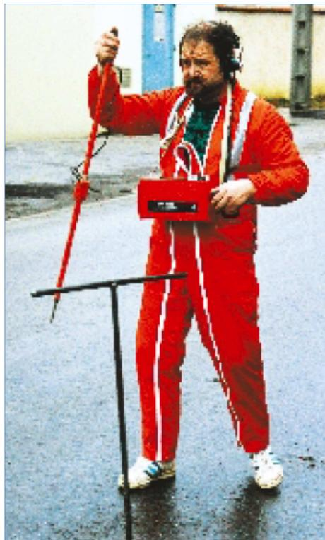
**Imagen 2.5.** Utilización del fonómetro en la localización de fugas
