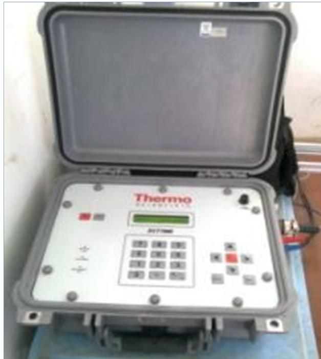
**Imagen 2.1.** Caudalímetro ultrasónico DCT 7088
