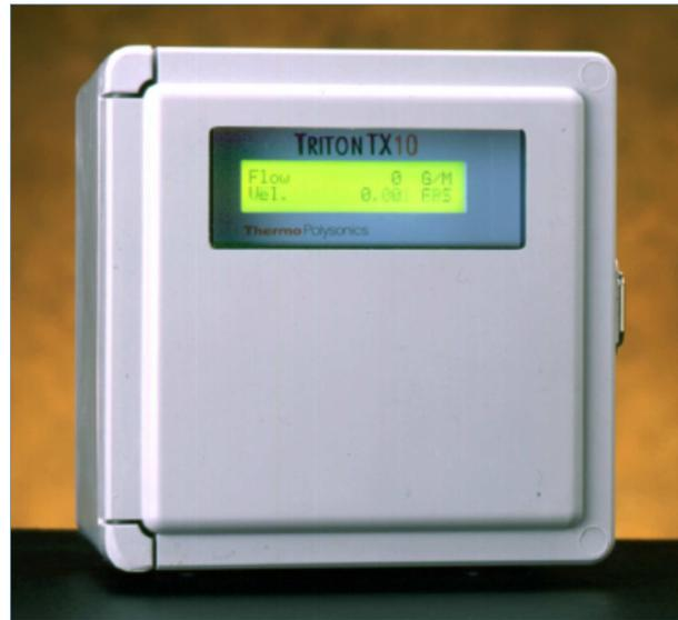
**Imagen 2.6.** Medidor de flujo del tiempo de tránsito “tritón tx10”
