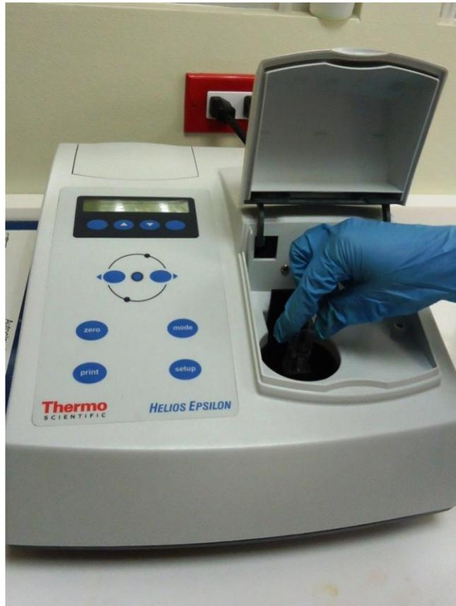
**Figura 3.4** Espectrofotómetro ThermoScientific para la medición de  $\text{Fe}^{+2}$ , Fe Total, Sulfato. **Fuente:** Autor
