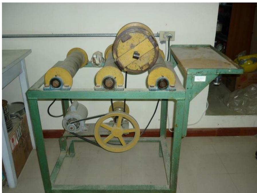
**Figura 3.1** Molino de Bolas de laboratorio para molienda. **Fuente:** Autor
