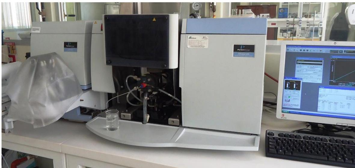
**Figura 3.5** Espectrómetro de Absorción Atómica. **Fuente:** Autor
