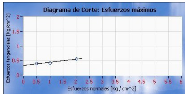
Fig. 4.8 Diagrama de corte mediante aplicación daq, ensayo corte directo
