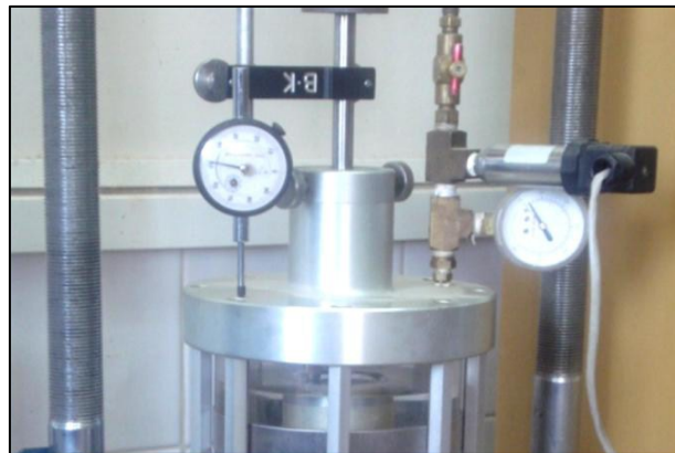
Fig. F.2 Cámara triaxial llenada con agua
