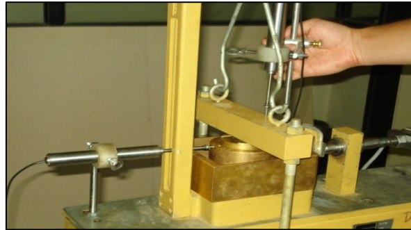
Fig. H.2 Configuración de los LVDT.
