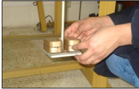
Fig. I.3 Colocación de cargas sobre el equipo de consolidación.
