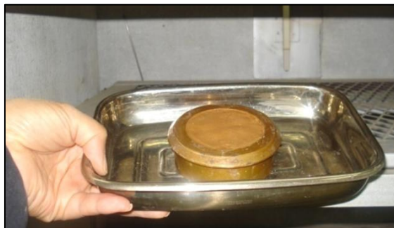
Fig. I.4 Secado al horno de la muestra.
