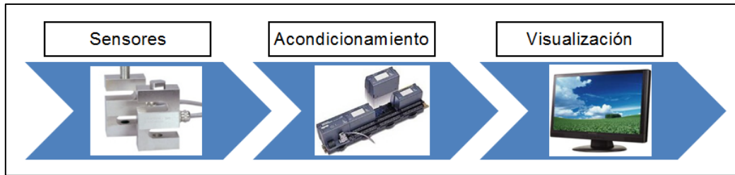
Fig. 1.1 Etapas de un sistema de medición digital
