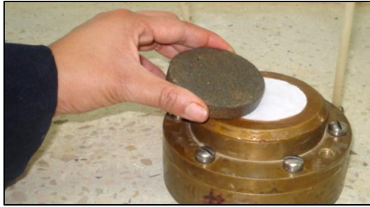
Fig. I.1 Ensamblado de la caja de consolidación
