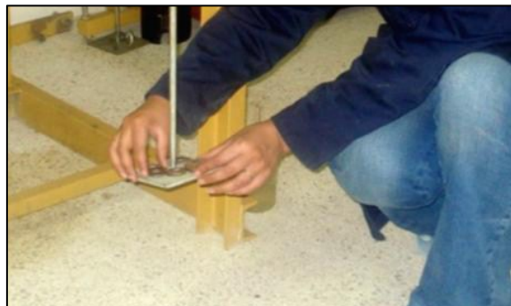
Fig. I.2 Colocación de carga de asentamiento.
