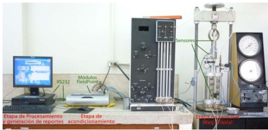
Fig. 5 Configuración física de la aplicación DAQ con la máquina Triaxial
