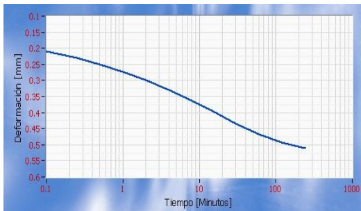
Fig. 13 Etapa de análisis de datos, ensayo Consolidación
