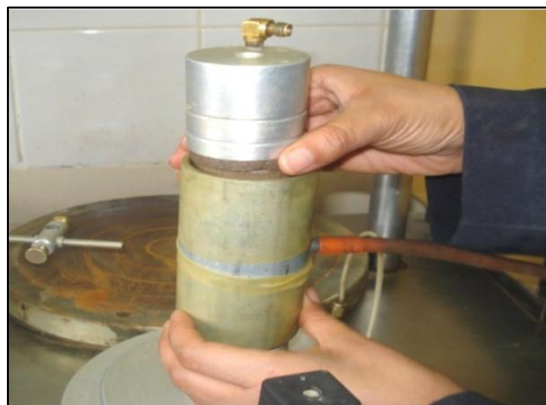
Fig. F.1 Colocación de la membrana a la probeta
