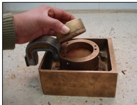
Fig. H.1 Ensamble de la caja de corte.
