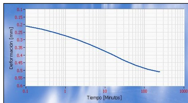
Fig. 3.11 Análisis de datos del ensayo de consolidación
