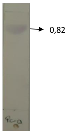
Figura.7. TLC (Hex:AcOEt) de la Fracción 21-23 luego de ser revelada con ácido sulfúrico y vainillina y se muestra su Rf 0,82.
