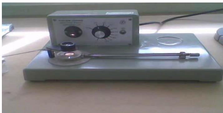
Figura 5: Equipo de fusión Fisher-Johns- Melting PointApparatus serial 40-22.
