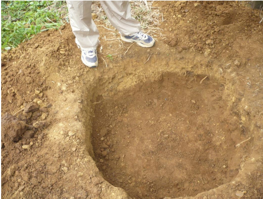
Ilustración9: Muestreo para ensayos de suelo
