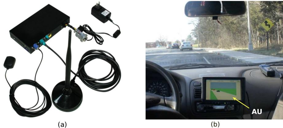
**Figura 2.4:** Equipamiento para comunicaciones vehiculares: a) Unidad a bordo (OBU), b) Unidad de aplicaciones (AU) [15]
