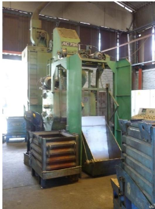
**Horno de baja presión:** No tiene un órgano de parada que permite la detención total en condiciones de seguridad, el acceso y la permanencia sobre la máquina no son seguros en el mantenimiento y la limpieza del horno.
