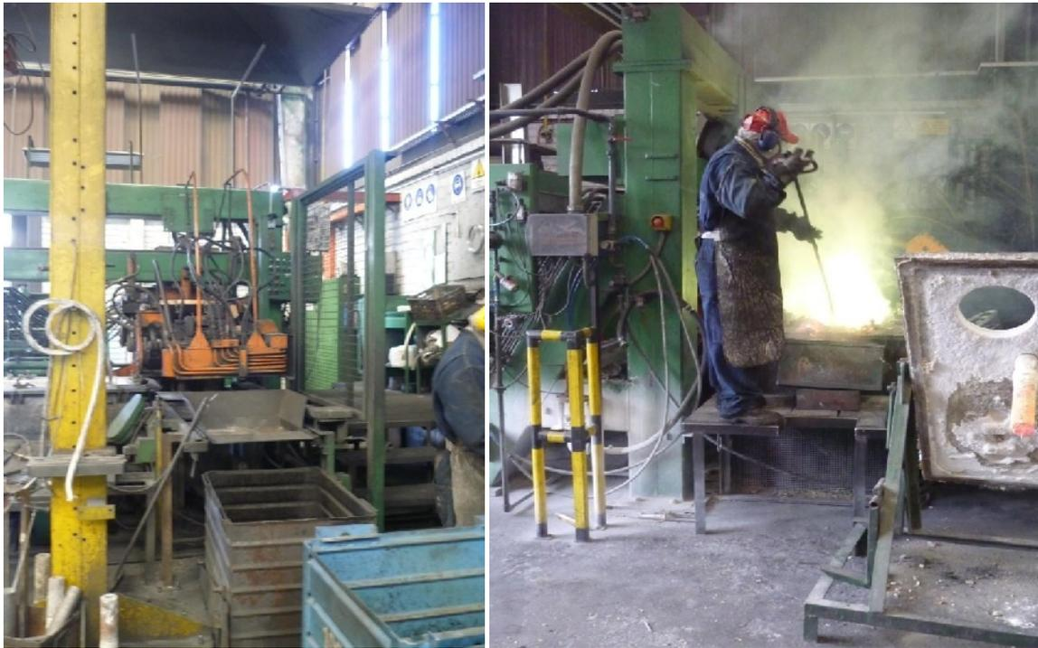
**Sierra en cinta:** No hay protección contra la proyección de material particulado metálico, ni protección contra la rotura de la sierra metálica, no se cuenta con guardas de protección.
