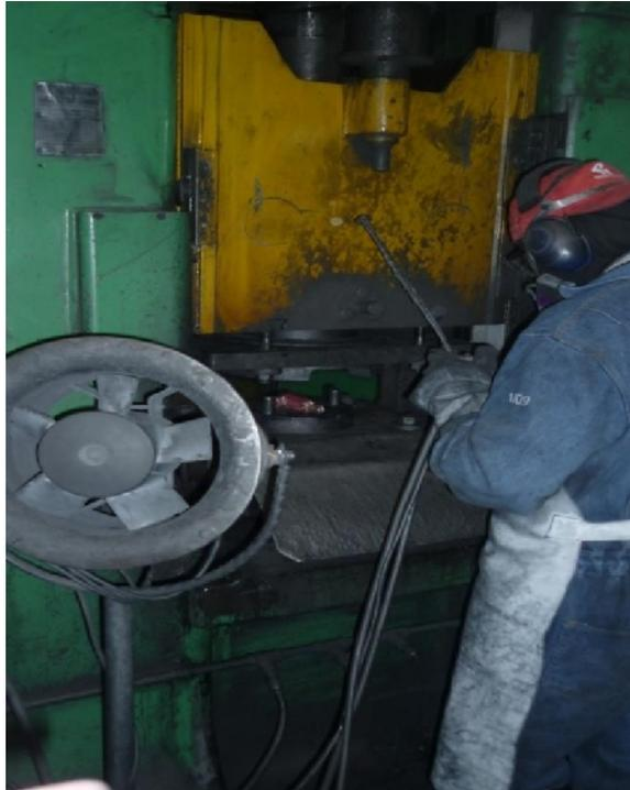
**Inyectora de alta presión:** Peligro por manipulación involuntaria de los órganos de accionamiento, no existen protecciones contra la proyección de metal líquido, no posee resguardos que impidan el acceso a zonas peligrosas.
