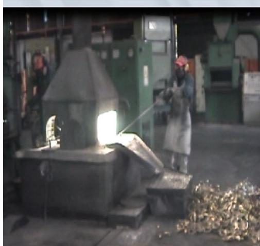
**Prensa:** El accionamiento no permite al operador comprobar la ausencia de personas en la zona de peligro, no hay un órgano de parada que permite la detención total en condiciones de seguridad, no existen protecciones contra la proyección de material particulado incandescente, el acceso y la permanencia sobre el equipo no son seguros, no cuenta con resguardos que impidan el acceso a zonas peligrosas.
