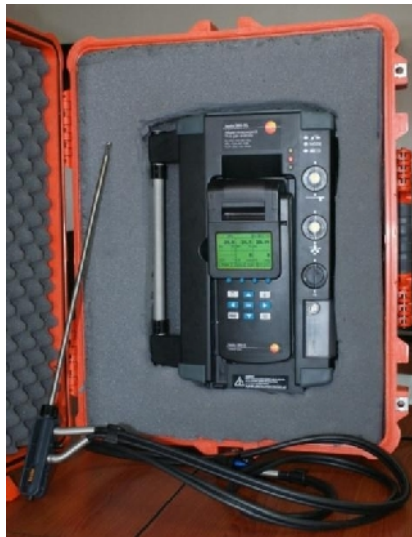
Fotografía 7: Analizador de gases
