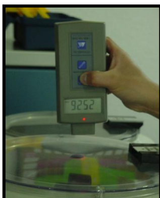
Figura 41. Medición RPM con fototacómetro
