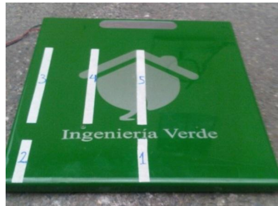
Fig. 18. Zonificación de la baldosa piezoeléctrica para la prueba de presión
