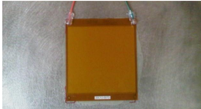
Fig. 4.2. Compuesto de macrofibras incrustado en el interior de la baldosa PowerLeap.
