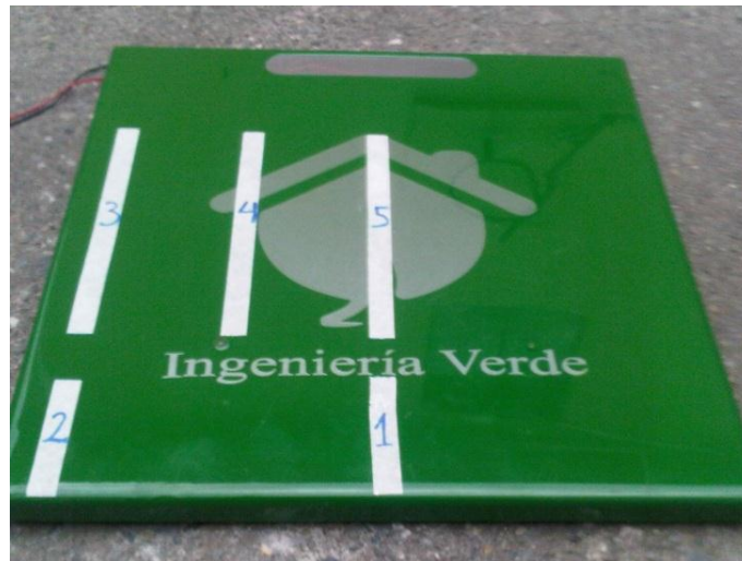
Fig. 4.10. Zonificación de la baldosa piezoeléctrica para la prueba de presión.
