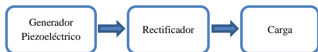
Fig. 9. Diagrama de bloques básico para el harvesting de energía de la marcha en las baldosas piezoeléctricas [12].
