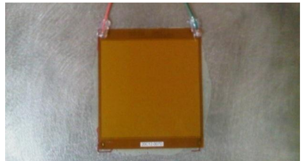
Fig. 12. Compuesto de macrofibras incrustado en el interior de la baldosa PowerLeap.
