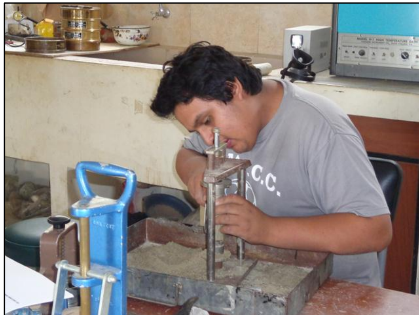
Fotografía VI.8.- Preparación de la muestra para el ensayo de compresión triaxial. Fuente: El autor
