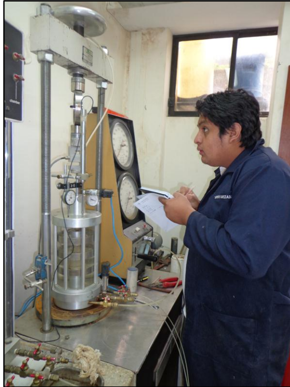
Fotografía VI.9.- Ensayo de compresión triaxial. Fuente: El autor.
