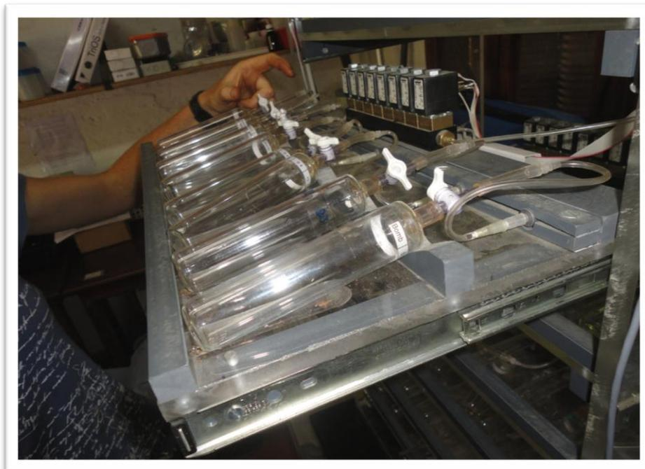
**Figura 41.** Lectura de muestras de N<sub>2</sub>O por cromatografía de gases.
