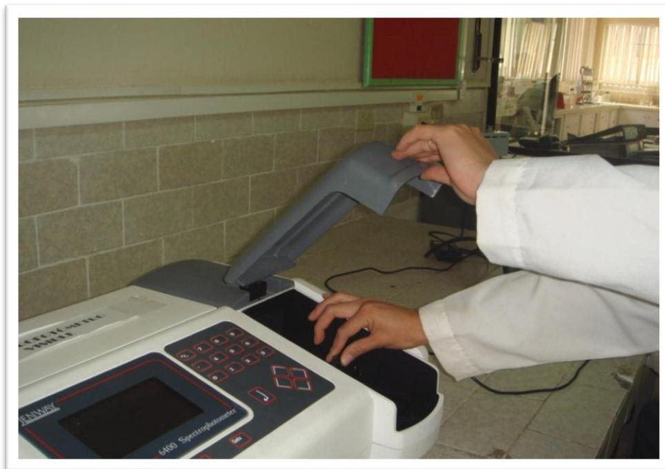
**Figura 43.** Análisis de las muestras de suelos por espectrofotometría.
