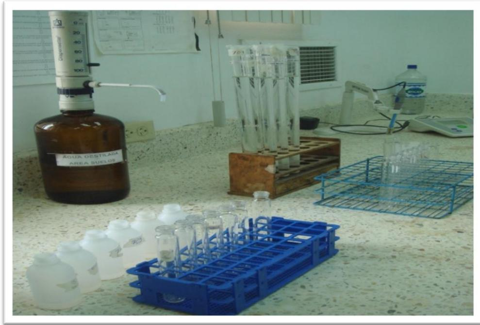
**Figura 42.** Preparación de muestras de suelos para análisis de nitrógeno fósforo y potasio.
