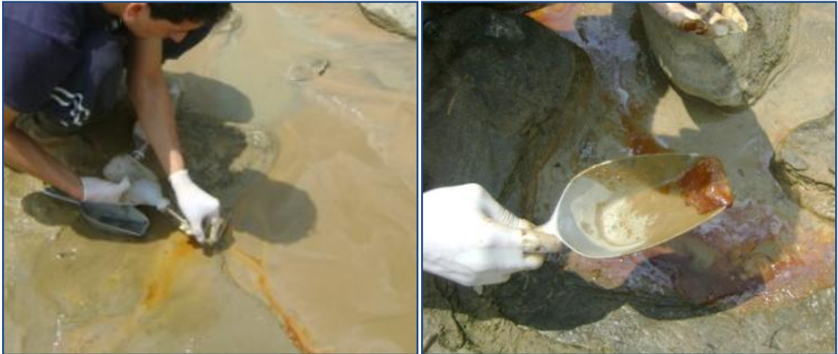
a. Flujo ácido con fuerte coloración rojiza dada por especies oxidadas de hierro.
