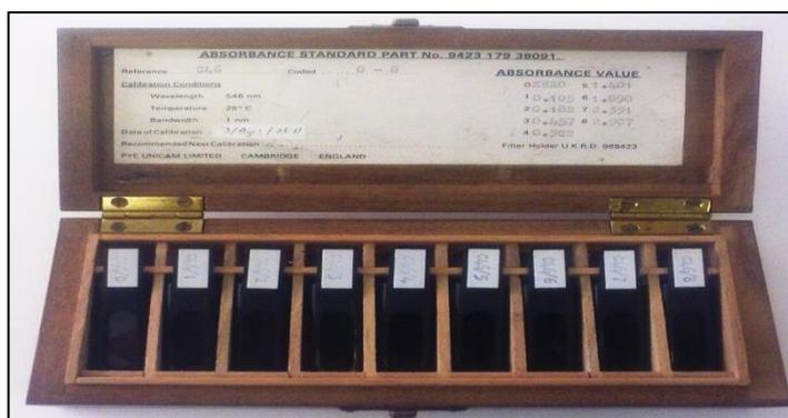
Figura 11 Filtros para verificación del Espectrofotómetro
