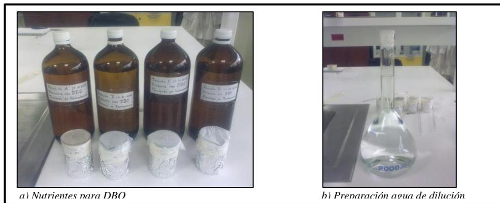
Figura 2 Preparación de nutrientes para DBO
