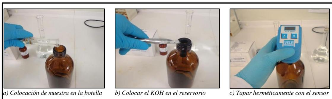
Figura 4 Colocación de las muestras, reactivos y tapado de la botella para DBO
