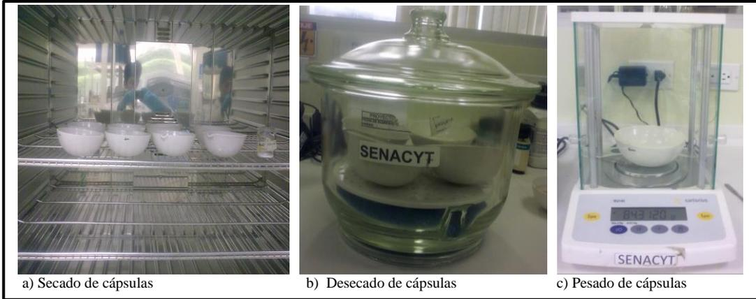
**Figura 16 Preparación cápsulas**
