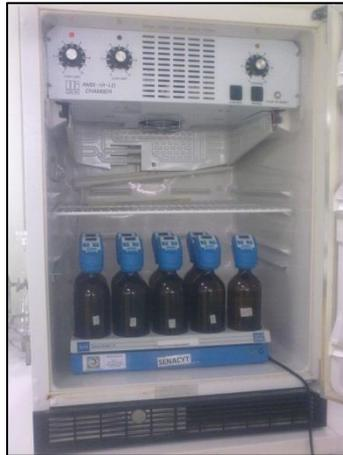
Figura 5 Botellas de DBO en la incubadora a 20°C
