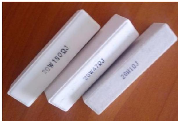
**Fig.3.9.** Resistores cerámicos de alta potencia utilizados como carga para la obtención de los pares (I,V) de la curva I-V de la lámina solar
