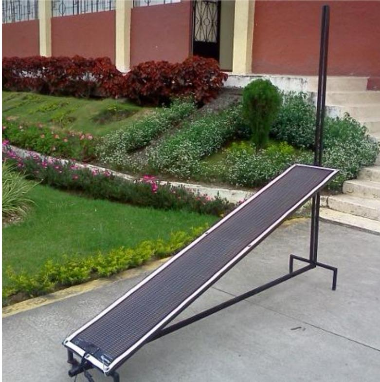
**Fig.4.1.** Estación experimental para la obtención de la curva IV de la lámina solar, con ángulo de inclinación de 20° respecto de la horizontal
