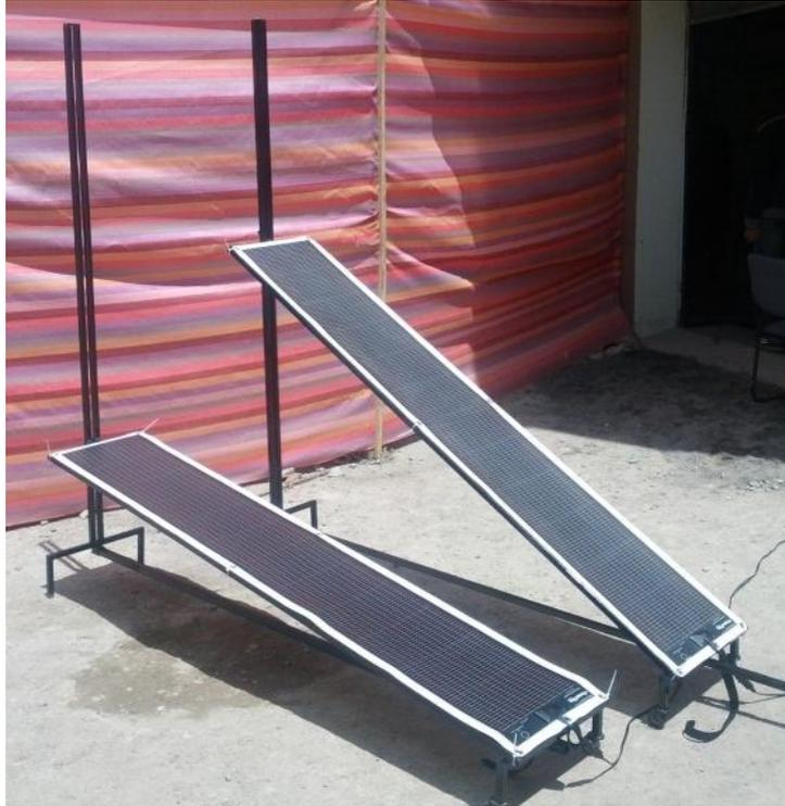
**Fig.4.3.** Obtención de la curva IV de las láminas solares, con diversos ángulos de inclinación respecto de la horizontal
