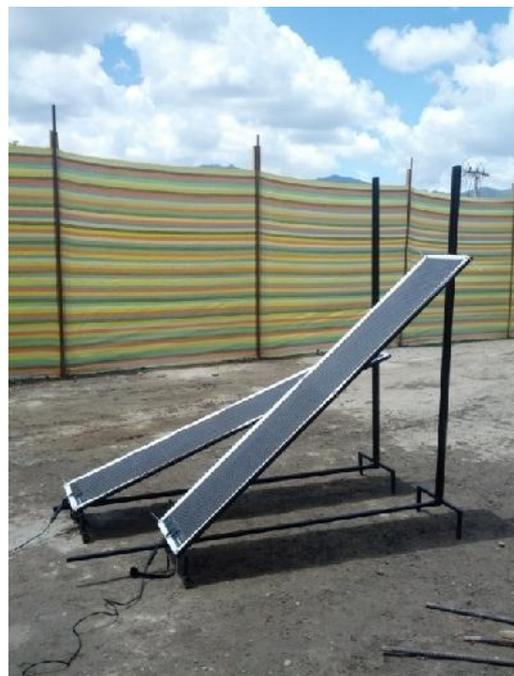
**Fig.6.** Soporte mecánico construido para experimentación de las láminas solares PowerFilm.
