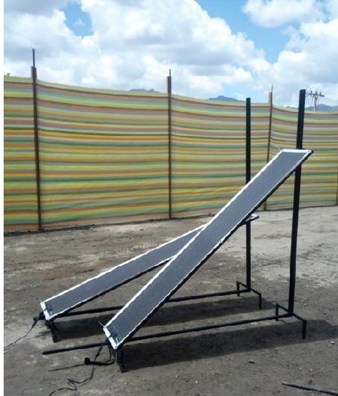
**Fig.3.6.** Soporte mecánico construido para experimentación de las láminas solares PowerFilm
