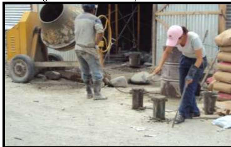
Figura 6. Realización de los Especímenes Cilíndricos
