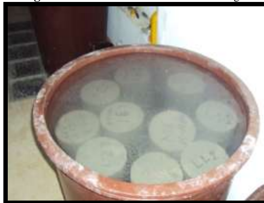
Figura 7. Curado de los Cilindros de Hormigón
