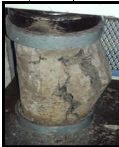
Figura 8. Ruptura de los Especímenes Cilíndricos
