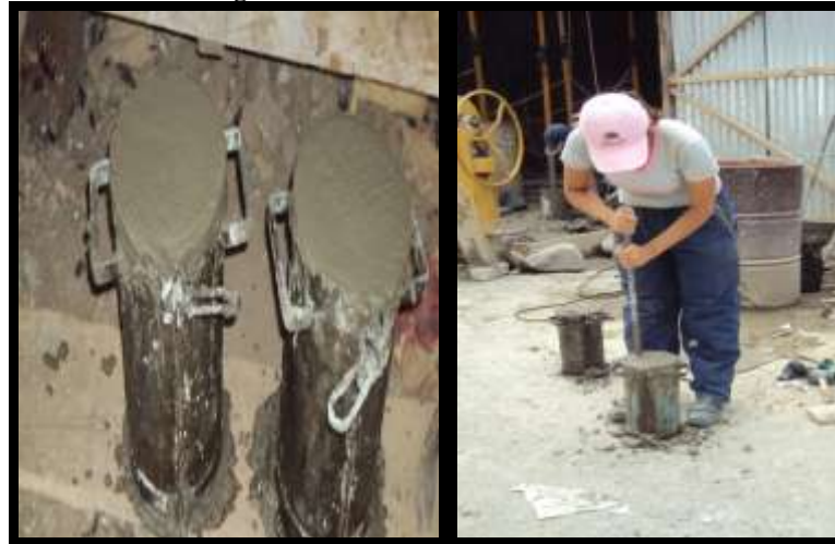
Figura 11. Realización de las Probetas Cilíndricas
