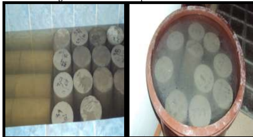
Figura 12. Curado de los Especímenes Cilíndricos
