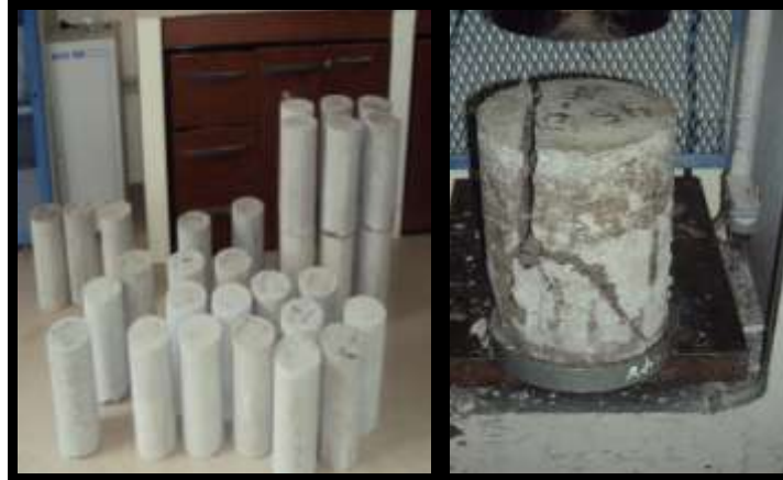
Figura 13. Ruptura de los Especímenes Cilíndricos
