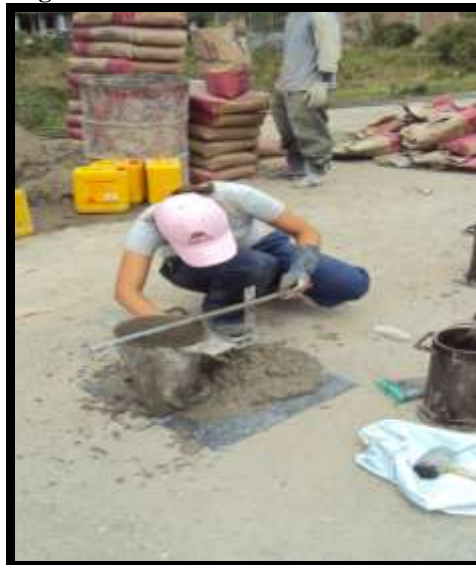
Figura 10. Realización de la Prueba de Asentamiento
