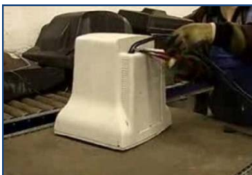
Fig. V.4 Corte de cables de alimentación 10
