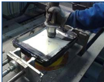
Fig. 8.5 Retiro de elemento fosforado del vidrio de pantalla
