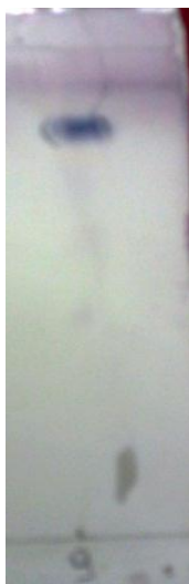
Figura 14. Cromatograma revelada de las fracciones LF9, luego del proceso de purificación. Fase estacionaria: Sílica gel, y fase móvil Hex-AcOEt 1:1
