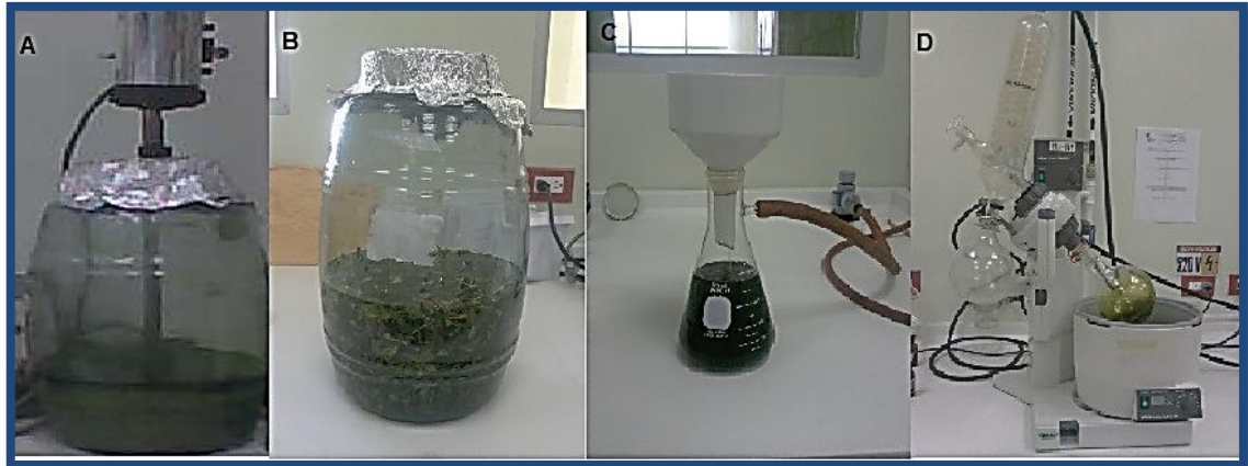
Figura 4. Obtención de los extractos. a. Maceración dinámica (5min), b. Maceración estacionaria (55min), c. Filtración al vacío, d. Rotaevaporación.
