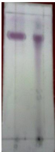
Figura 12. Cromatograma revelado de las fracciones LF7, y su agua madre posterior al proceso de purificación. Fase estacionaria: Sílica gel, y fase móvil Hex-AcOEt 1:1
