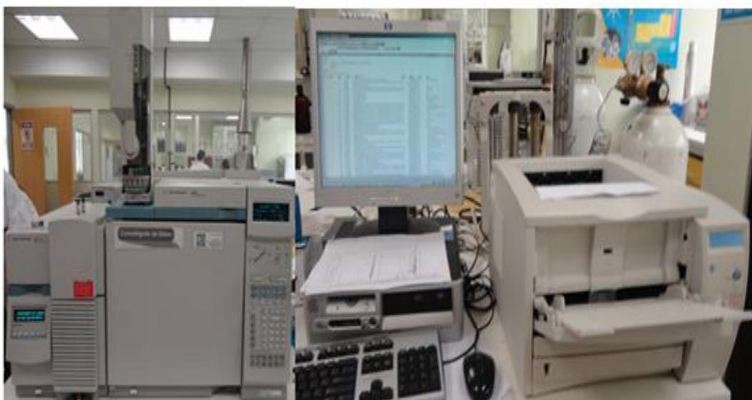
Fotografía 7: Cromatógrafo de Gases Agilent 6890N
