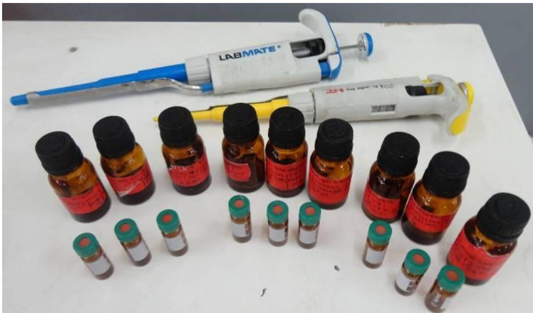
**Fotografía 8.** Preparación de las muestras de los aceites esenciales para las inyecciones cromatográficas
