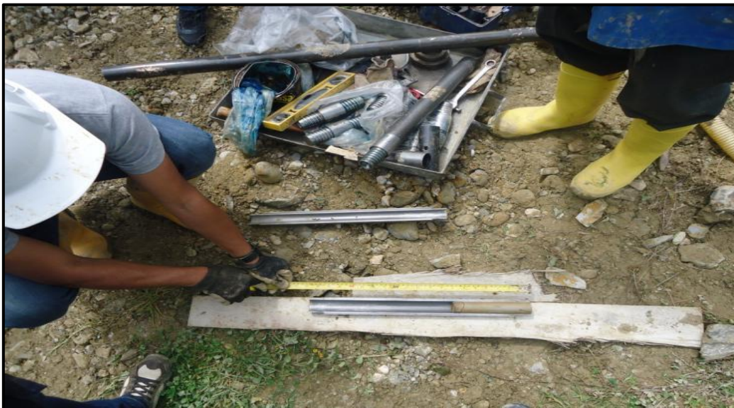
Foto 15.- Muestra obtenida en la realización del ensayo SPT
