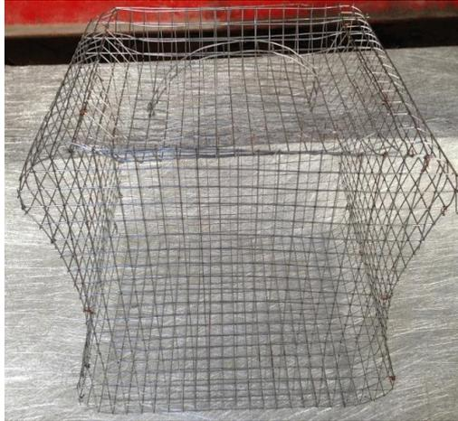
**Fig. 3.19.** Molde de malla de alambre. Fotografía de los autores.
