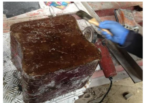
**Fig. 29.** Aplicación de la mezcla sobre la fibra en el exterior del molde. Fotografía de los autores.
