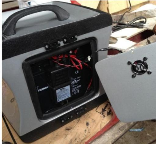
**Fig. 3.33.** Empaque de caucho aplicado en la tapa del equipo. Fotografía de los autores.
