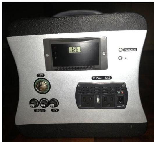
**Fig. 3.36.** Módulo principal del equipo solar. Cara frontal, con etiquetas. Fotografía de los autores.
