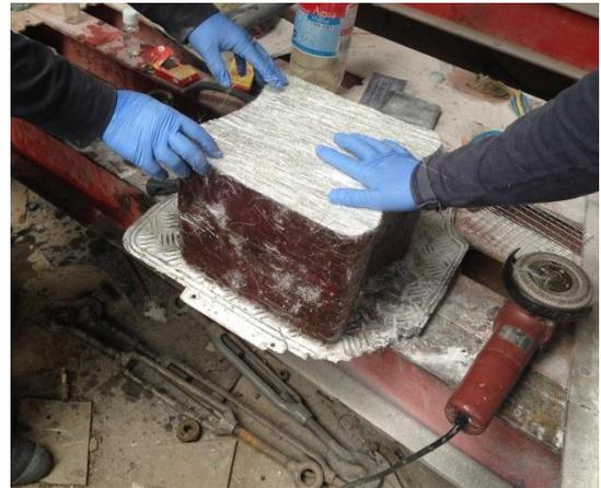
**Fig. 28.** Colocación de la fibra de vidrio en el exterior del molde. Fotografía de los autores.
