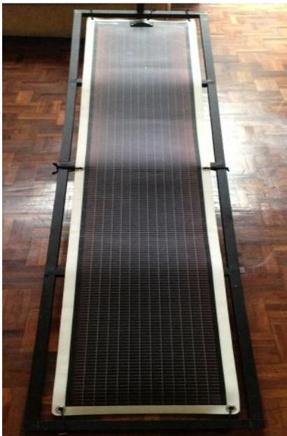
**Fig. 22.** Estructura para soporte de la lámina solar, fabricada en aluminio. Fotografía de los autores.
