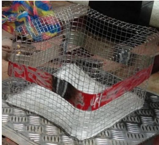
**Fig. 3.21.** Colocación de la fibra de vidrio en el interior del molde. Fotografía de los autores.
