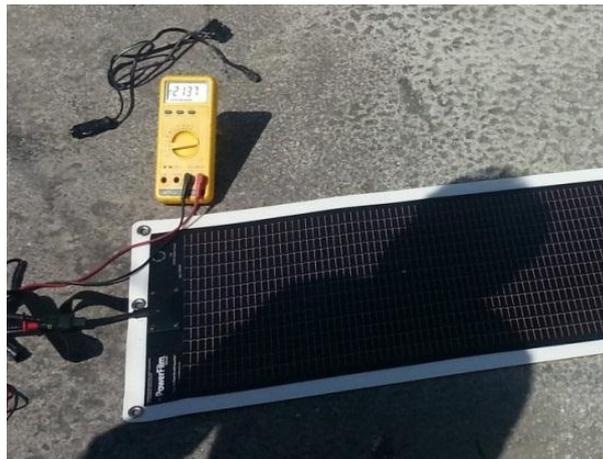
**Fig. 2.7.** Instalación de verificación del desempeño de las láminas solares en la latitud de Loja.
