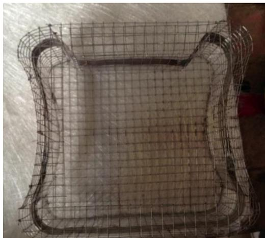
**Fig. 3.20.** Anillo de lámina metálica negra, para reforzar el molde. Fotografía de los autores.
