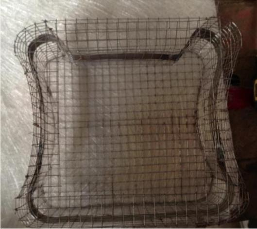
**Fig. 25.** Anillo de lámina metálica negra, para reforzar el molde. Fotografía de los autores.
