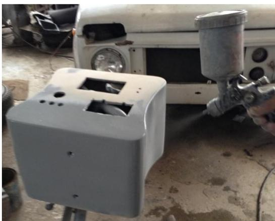
**Fig. 35.** Aplicación del fondo en el molde. Fotografía de los autores.
