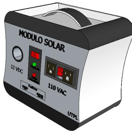
**Fig. 2.12.** Vista frontal de la estructura mecánica sugerida para el montaje del módulo. Diseño de los autores.
