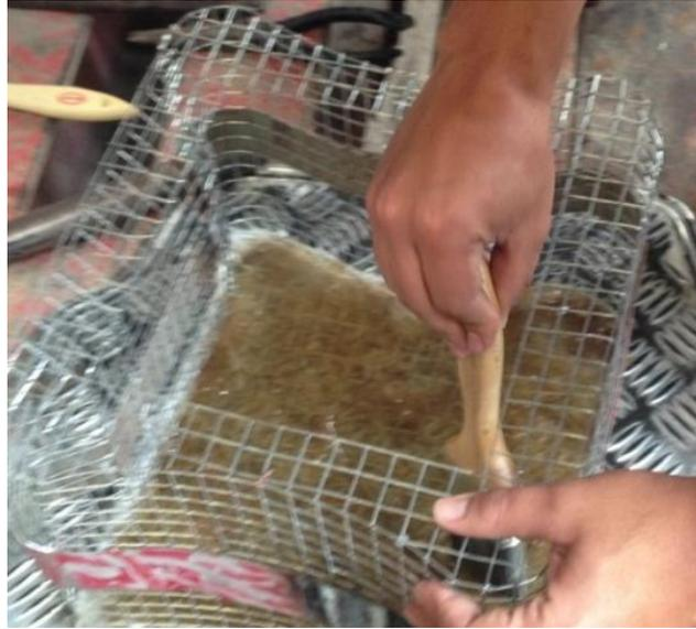
**Fig. 3.23.** Aplicación de la mezcla sobre la fibra. Fotografía de los autores.
