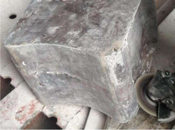
**Fig. 30.** Lijado del molde. Fotografía de los autores
