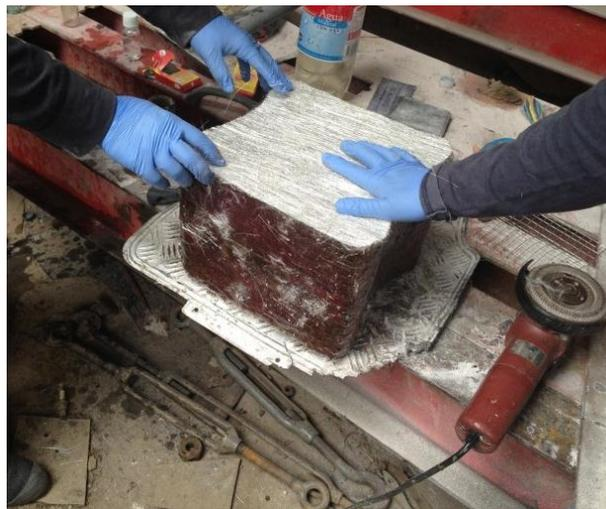
**Fig. 3.24.** Colocación de la fibra de vidrio en el exterior del molde. Fotografía de los autores.
