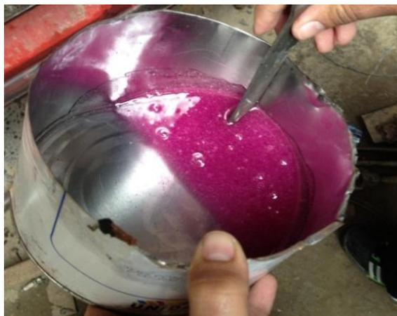
**Fig. 3.22.** Preparación de resina, catalizador, y, acelerante. Fotografía de los autores.
