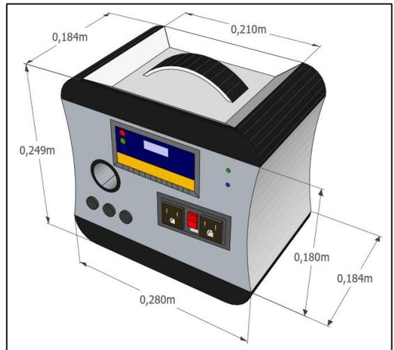
**Fig. 15.** Vista frontal y geometría del módulo a construir. Elaborado por los autores.
