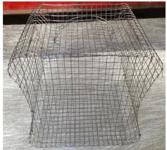
**Fig. 23.** Molde de malla de alambre. Fotografía de los autores.
