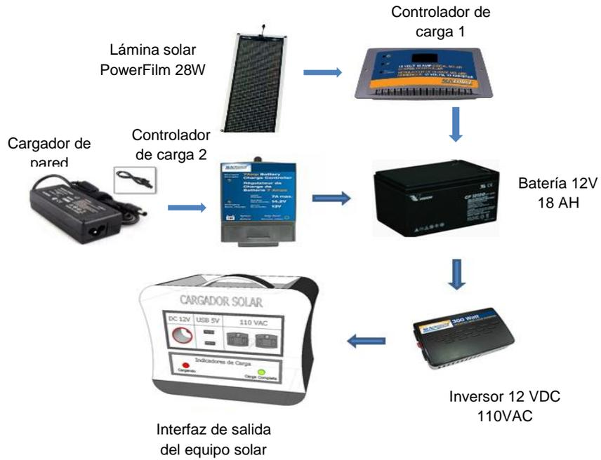
**Fig. 3.7.** Diagrama corregido de bloques del sistema. Elaborado por los autores.
