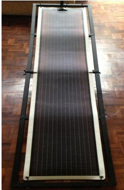
**Fig. 3.18.** Estructura para soporte de la lámina solar, construida en aluminio. Fotografía de los autores.
