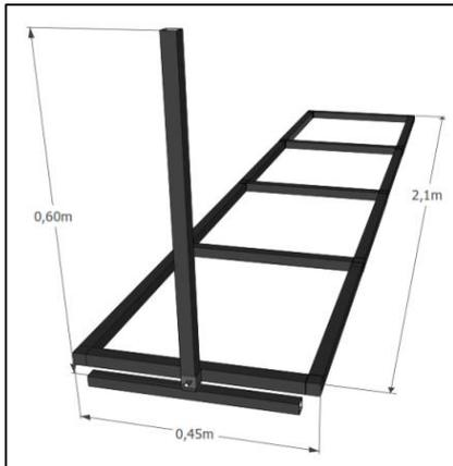
**Fig. 20.** Geometría de la estructura de soporte de la lámina solar. Elaborado por los autores.
