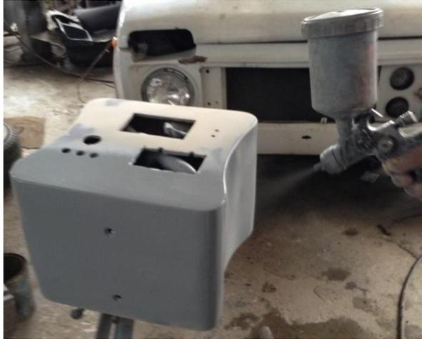
**Fig. 3.31.** Aplicación del fondo en el molde. Fotografía de los autores.
