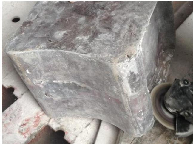
**Fig. 3.26.** Lijado del molde. Fotografía de los autores.
