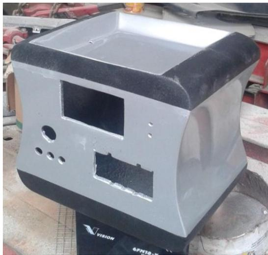
**Fig. 3.32.** Molde pintado y con autoforce en sus bordes. Fotografía de los autores.
