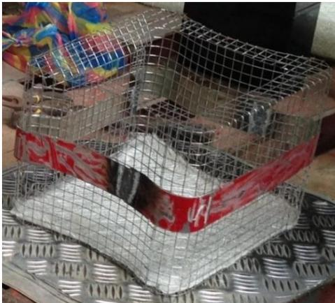
**Fig. 25.** Colocación de la fibra de vidrio en el interior del molde. Fotografía de los autores.
