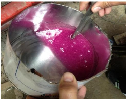
**Fig. 26.** Preparación de resina, catalizador, y acelerante. Fotografía de los autores.
