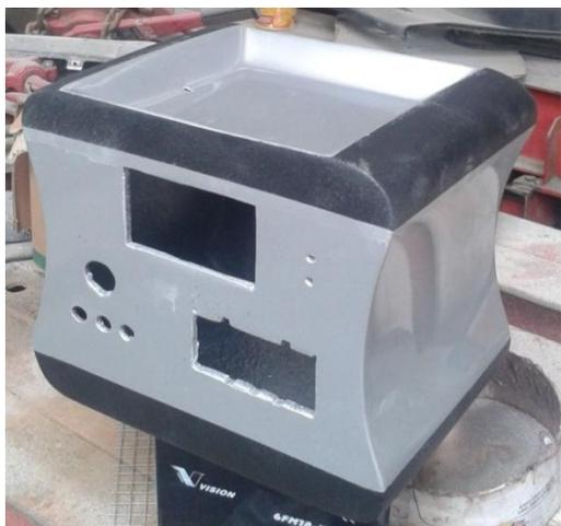
**Fig. 36.** Molde pintado y con autoforce en sus bordes. Fotografía de los autores.
