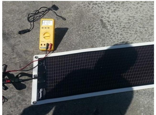
Fig. 6. Instalación de verificación del desempeño de las láminas solares en la latitud de Loja. Fotografía de los autores.
