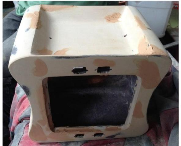
**Fig. 34.** Masillado del molde. Cara posterior. Fotografía de los autores.
