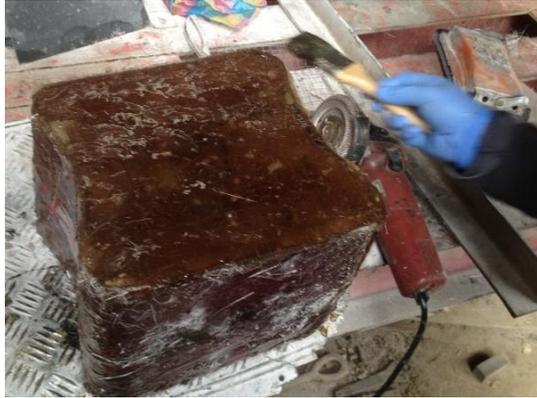
**Fig. 3.25.** Aplicación de la mezcla sobre la fibra en el exterior del molde. Fotografía de los autores.
