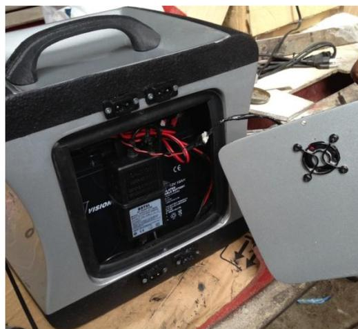
**Fig. 37.** Empaque de caucho aplicado en la tapa del equipo. Fotografía de los autores.
