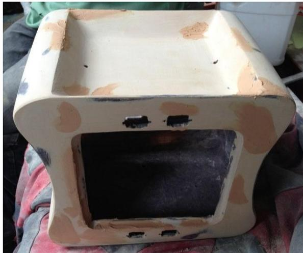
**Fig. 3.30.** Masillado del molde. Cara posterior. Fotografía de los autores
