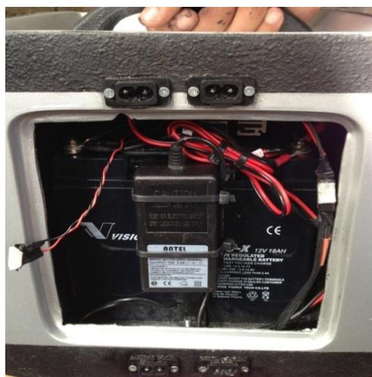
**Fig. 38.** Ubicación de la batería y del cargador de pared. Fotografía de los autores.
