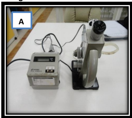
Fotografía 6: Índice de refracción A) refractómetro; B) Lectura
