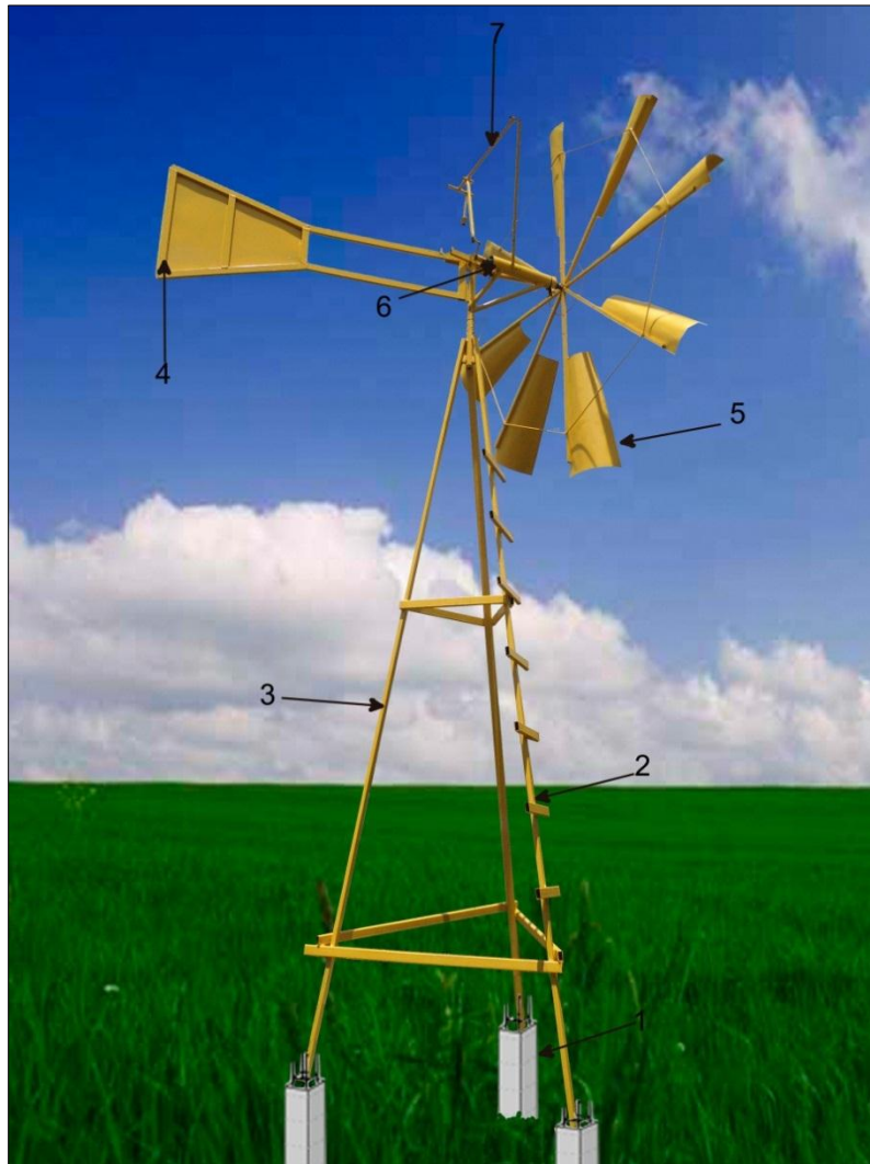
Figura 4. Elementos y principio de funcionamiento del aerobomba. Fuente: Autor
