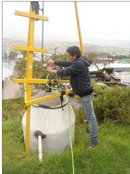
Figura 13. Cálculo del caudal con bombeo manual.
