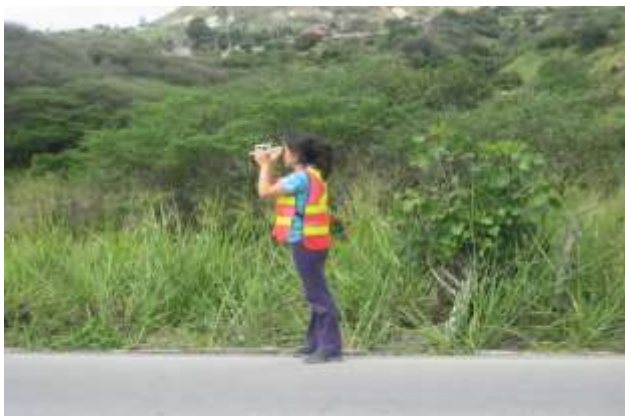
Imagen 3.4 Toma de pendientes con clinómetro
