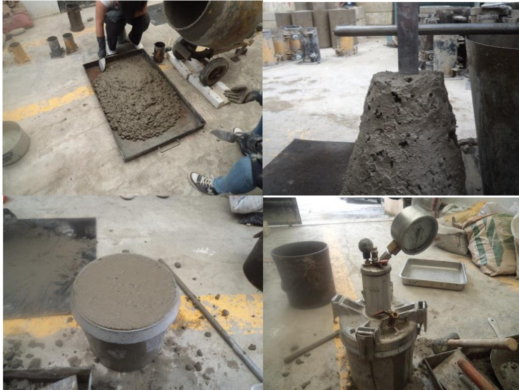
Figura 3.5 Características del hormigón fresco Fuente: Autora
