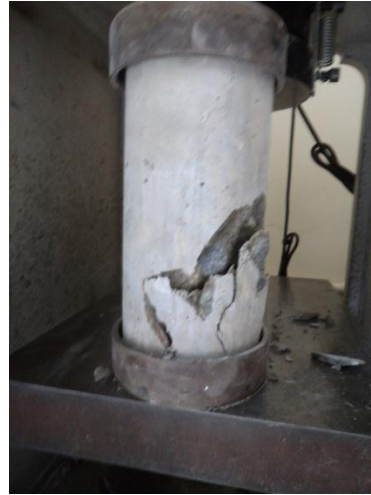
Figura 3.13 Falla Tipo 5 Fuente: Autora
