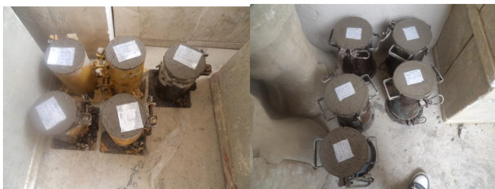
Figura. 3.6 Especímenes de 100x200 y 150x300 mm. Fuente: Autora
