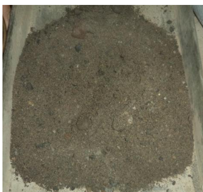
Figura. 3.1 Agregado fino Fuente: Autora
