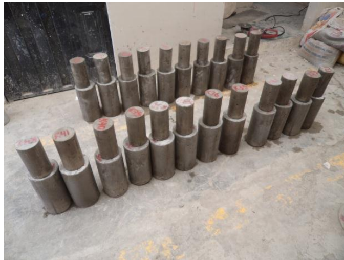
Figura 3.11 Especímenes a ensayarse de 200x100 mm y 300x150 mm Fuente: Autora
