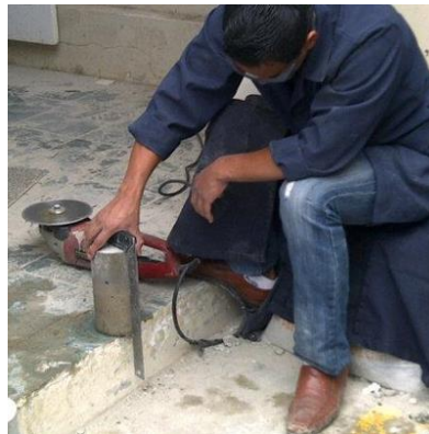
Figura 3.8 Verificación perpendicular y planeidad. Fuente: Autora
