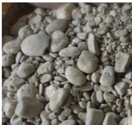
Figura. 3.2 Agregado grueso. Fuente: Autora
