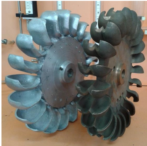
Figura 4.12. Turbinas Pelton y turgo a operar en el banco de pruebas. Fotografía de autores.
