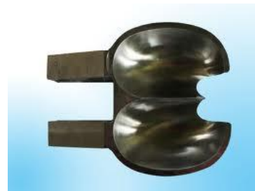
Fig.38. Adecuación realizada para variar la posición de la campana respecto al inyector. (a) Vista inferior de la campana, (b) Vista superior del módulo. [Fotografías de autores]
