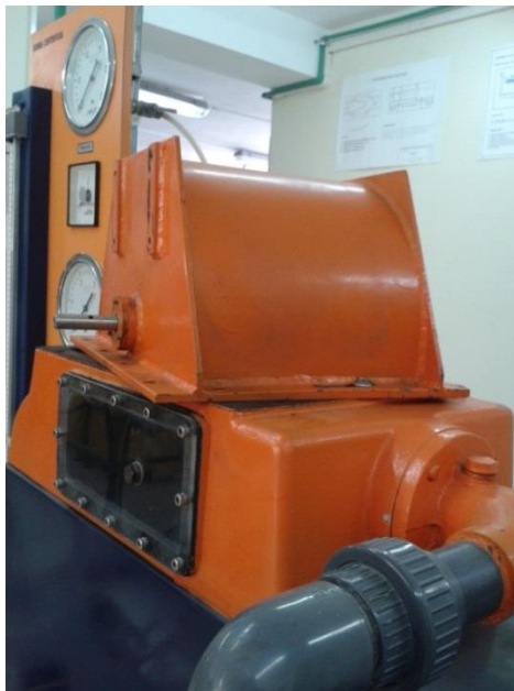
Figura 4.14. Turbina turgo montada en la campana del banco de pruebas y lista para experimentación. Fotografía de autores
