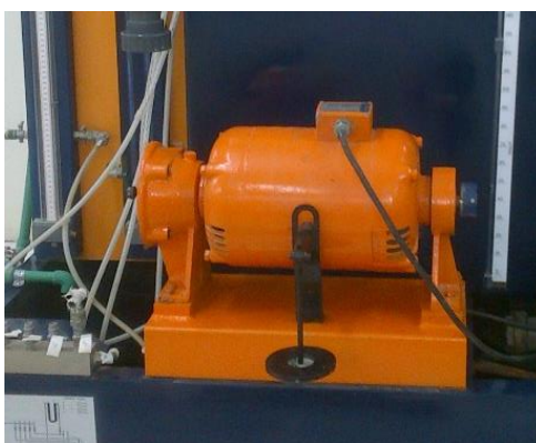
Figura 3.19. Motor original del banco de pruebas con sistema de medición del torque. Fotografía de autores.
