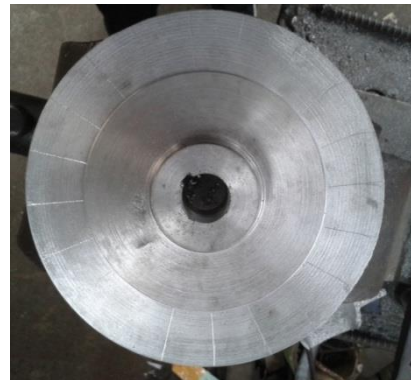
Fig. 44. División del disco de la turbina turgo [Fotografía de autores]
