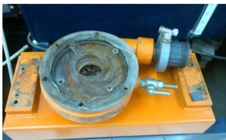
Fig. 25. Vista frontal de la cámara del rodete de la bomba centrífuga. [Fotografía de autores]
