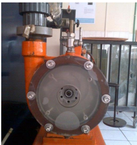
Figura 3.18. Instalación de la nueva cubierta de la cámara del rodete de la bomba centrífuga. Fotografía de autores.
