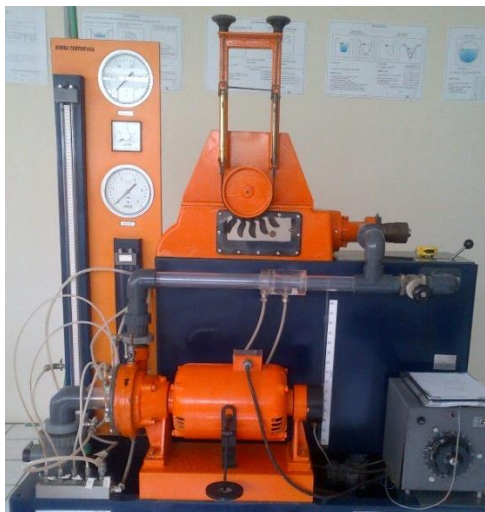
Figura 3.2. Vista general del banco de pruebas para el estudio de bombas centrífugas, al momento de la inspección inicial. Fotografía de autores
