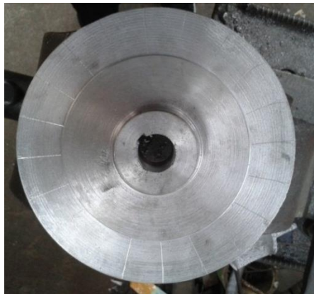
Figura 4.9. División del disco de la turbina turgo. Fotografía de autores.
