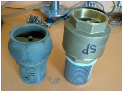
Fig. 23 Válvulas de pie (antigua y nueva). [Fotografía de autores]
