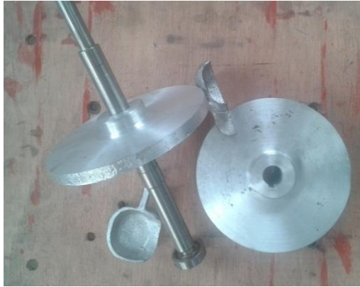
Figura 4.8. Elementos de la turbina tipo turgo listos para ensamblaje. Fotografía de autores.
