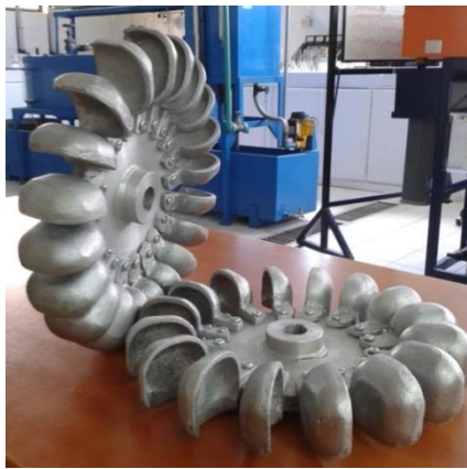
Fig. 46. Turbinas turgo construidas [Fotografía de autores]
