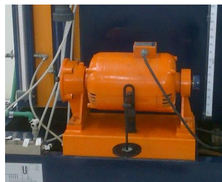
Fig. 29. Motor original del banco de pruebas con sistema de medición del torque. [Fotografía de autores]
