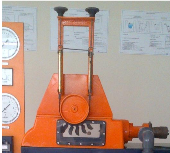
Figura 2.7. Estructura del bloque para experimentación de la turbina tipo Pelton, instalado en el banco de pruebas. Fotografía de autores
