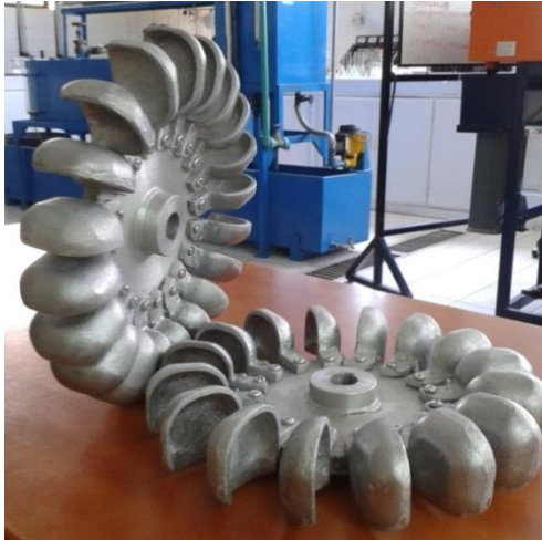
Figura 4.11. Turbinas turgo construidas. Fotografía de autores.
