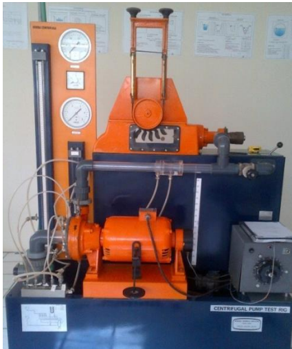
Fig. 12. Vista general del banco de pruebas para el estudio de bombas centrífugas, al momento de la inspección inicial. [Fotografía de autores]
