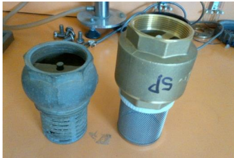
Figura 3.13. Válvulas de pie (antigua y nueva). Fotografía de autores.
