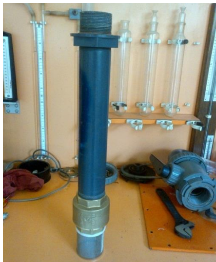
Figura 3.14. Instalación de la válvula de pie en el circuito de aspiración de la bomba. Fotografía de autores.
