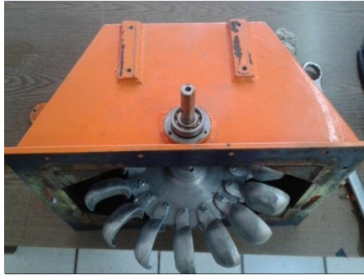
Figura 4.13. Turbina turgo montada en la campana del banco de pruebas. Fotografía de autores
