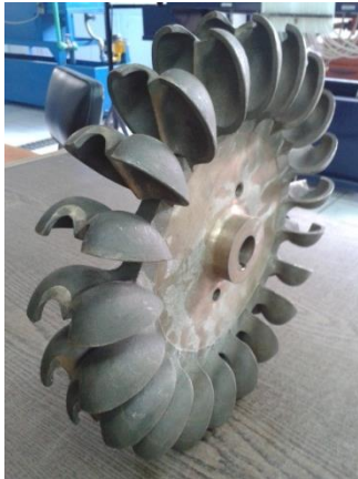
Fig. 41. Turbina tipo Pelton existente en el banco de pruebas. [Fotografía de autores]
