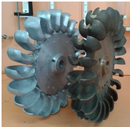
Fig. 47. Turbinas Pelton y turgo a operar en el banco de pruebas [Fotografía de autores]
