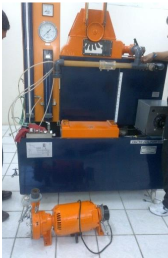
Fig. 36. Vista general del banco de pruebas de bombas centrífugas. En la parte superior se aprecia la posición del inyector y de la campana. [Fotografía de autores]
