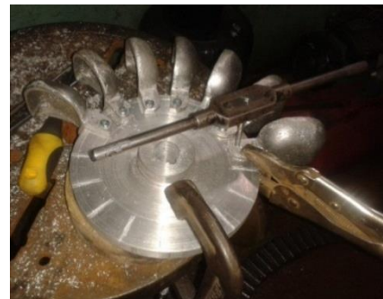
Fig. 45. Ensamblaje de los álabes al disco [Fotografía de autores]
