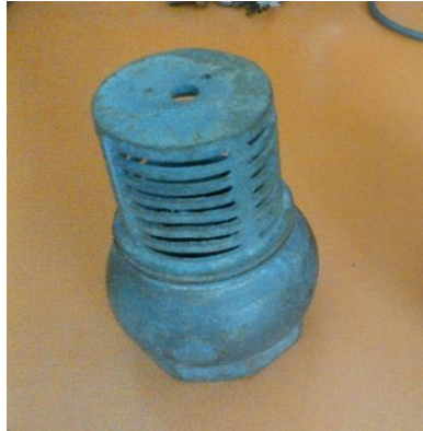
Figura 3.3. Estado inicial de la válvula de pie, a la entrada de la bomba. Fotografía de autores.
