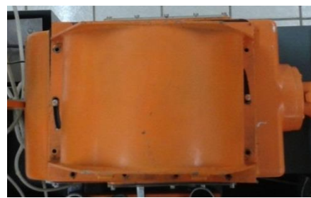
Fig.38. Adecuación realizada para variar la posición de la campana respecto al inyector. (a) Vista inferior de la campana, (b) Vista superior del módulo. [Fotografías de autores]
