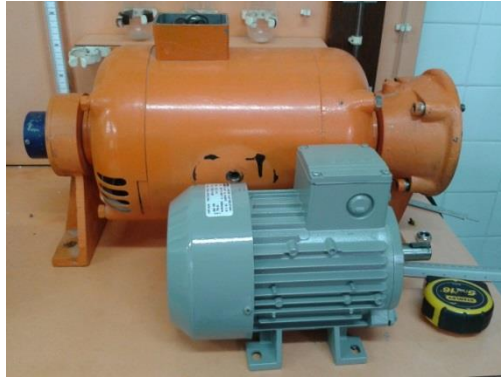
Figura 3.20. Variación de la geometría de los motores original y de reemplazo. Fotografía de autores.
