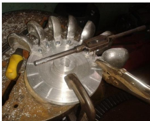
Figura 4.10. Ensamblaje de los álabes al disco. Fotografía de autores.
