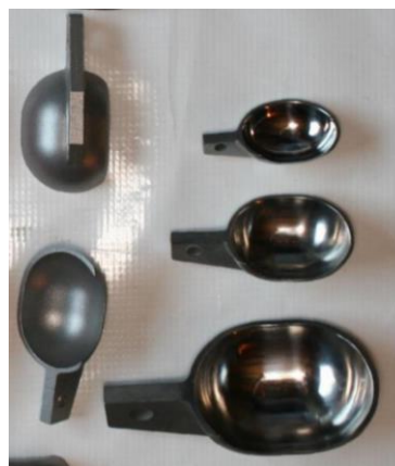
Fig.39. Álabes de turbinas de acción. (a) para turbinas Pelton [20], (b) para turbinas turgo [21]
