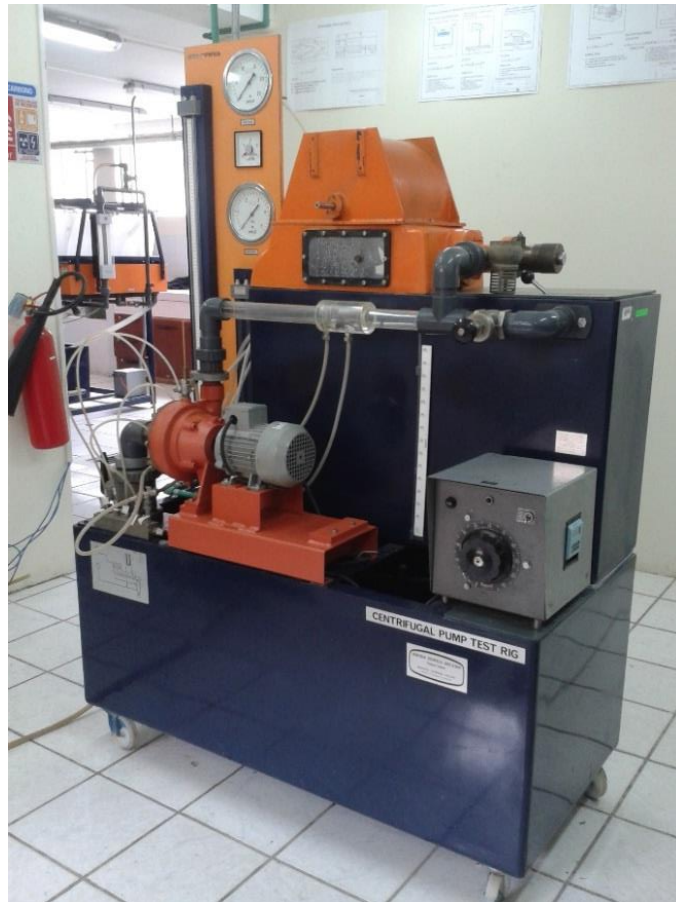
Figura 3.25. Vista frontal del banco de pruebas de bombas centrífugas rehabilitado. Fotografía de autores.
