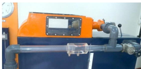
Figura 2.9. Tuberías de alimentación al inyector. Fotografía de autores
