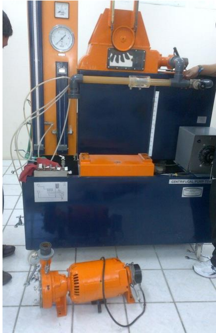
Figura 4.1. Vista general del banco de pruebas de bombas centrífugas. En la parte superior se aprecia la posición del inyector y de la campana. Fotografía de autores.
