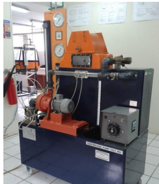
Fig. 35. Vista frontal del banco de pruebas de bombas centrífugas rehabilitado. [Fotografía de autores]
