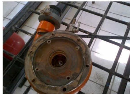
Fig. 26. Limpieza y remoción del empaque de la cámara del rodete. [Fotografía de autores]
