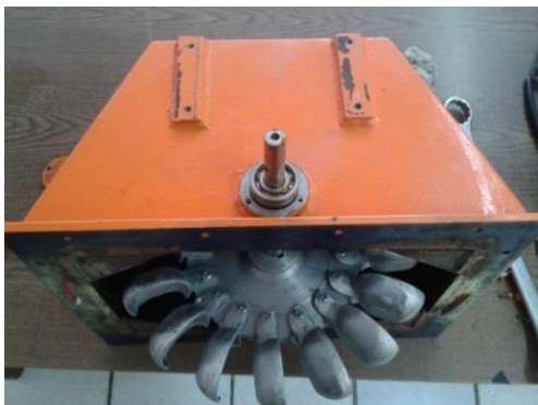
Fig. 48. Turbina turgo montada en la campana del banco de pruebas [Fotografía de autores]
