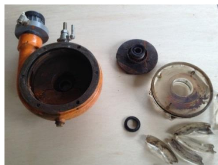
Fig. 27. Cámara del rodete de la bomba centrífuga, abierta. Se observa los efectos de la acumulación de óxido. [Fotografía de autores]
