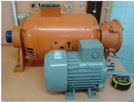
Fig. 30. Variación de la geometría de los motores original y de reemplazo. [Fotografía de autores]
