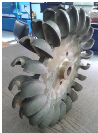
Figura 4.6. Turbina tipo Pelton existente en el banco de pruebas.
