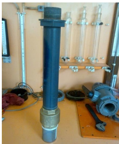
Fig. 24 Instalación de la válvula de pie en el circuito de aspiración de la bomba. [Fotografía de autores]
