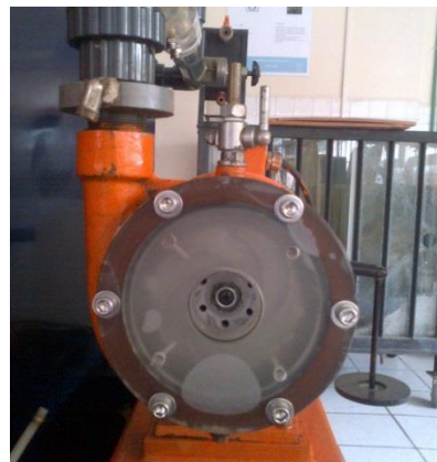
Fig. 28 Instalación de la nueva cubierta de la cámara del rodete de la bomba centrífuga. [Fotografía de autores]
