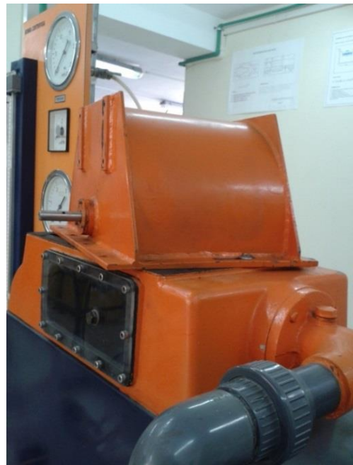
Fig. 49. Turbina turgo montada en la campana del banco de pruebas y lista para experimentación [Fotografía de autores]
