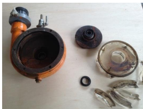
Figura 3.17. Cámara del rodete de la bomba centrífuga, abierta. Se observa los efectos de la acumulación de óxido. Fotografía de autores.
