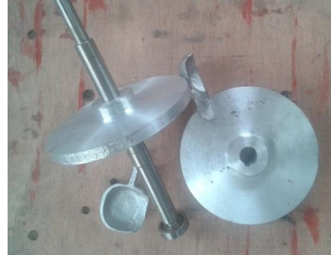
Fig. 43. Elementos de la turbina tipo turgo listos para ensamblaje [Fotografía de autores]
