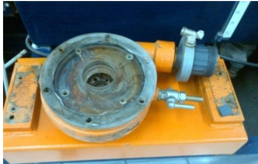
Figura 3.15. Vista frontal de la cámara del rodete de la bomba centrífuga. Fotografía de autores.
