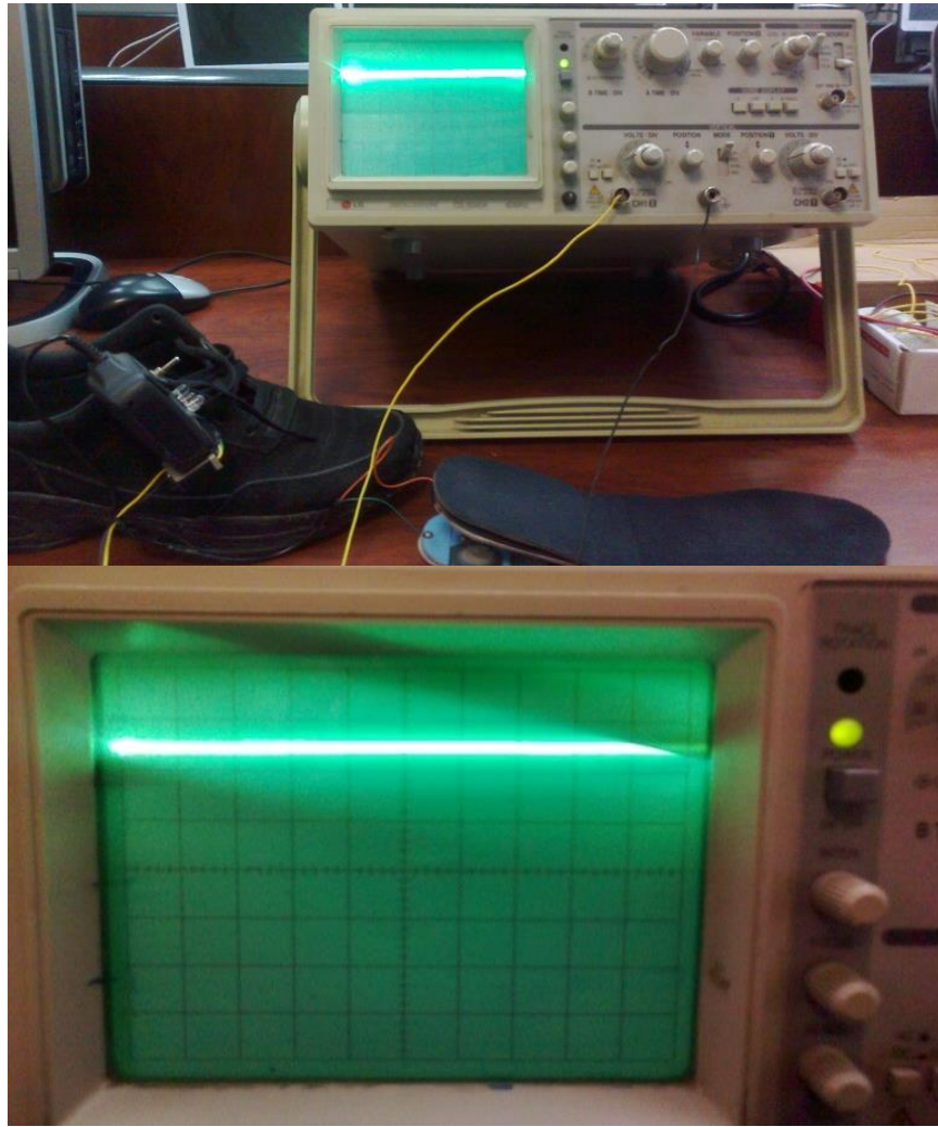
Fig. 4. 4. Señal de salida de la segunda plantilla piezoeléctrica, ante una excitación manual constante, y, una carga de un solo LED. Fuente: Fotografía de los autores.
