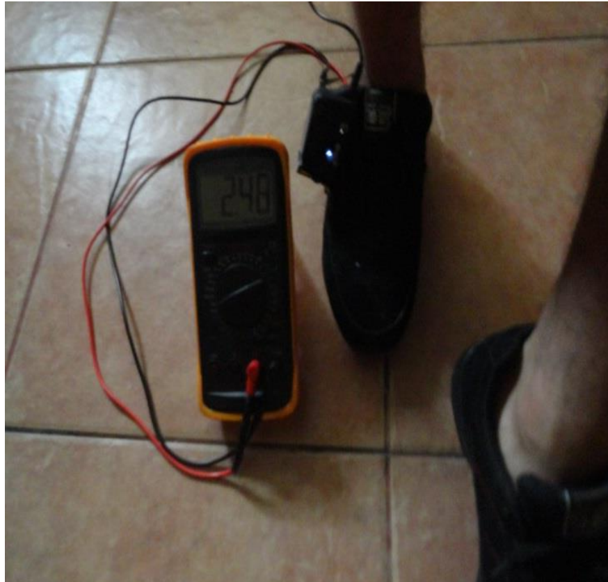
Fig. 4. 6. Vista general del equipamiento utilizado para evaluar el desempeño de las plantillas piezoeléctricas alimentando un único LED. Fuente: Fotografía de los autores.
