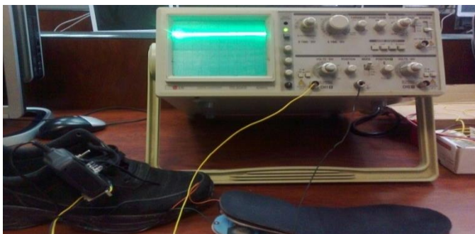
Fig. 29. Señal de salida de la segunda plantilla piezoeléctrica, ante una excitación manual constante, y, una carga de un solo LED. Fotografía tomada por los autores
