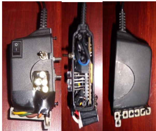
Fig. 3. 12. Caja de adaptador que contiene circuito, rectificador de señal, y, capacitor de carga. Fuente: Fotografía de los autores.
