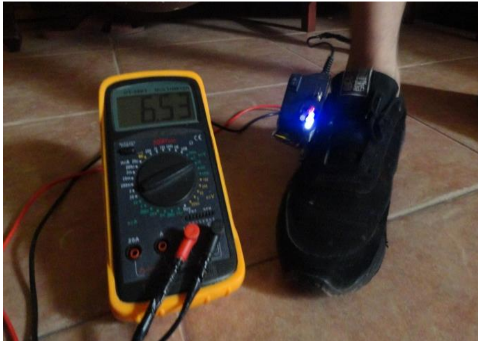
Fig. 4. 9. Vista general del equipamiento utilizado para evaluar el desempeño del tercer prototipo de plantilla piezoeléctrica, alimentando una carga de 3 LEDs conectados en serie. Fuente: Fotografía de los autores.
