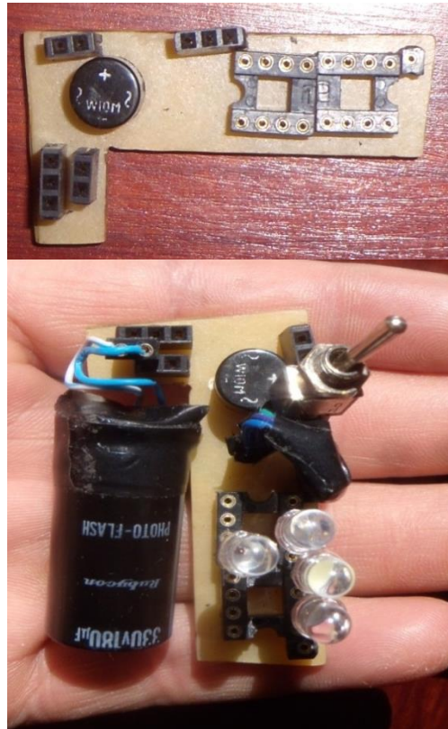
Fig. 3. 11. Circuito implementado en baquelita. Fuente: Diseño de los autores.
