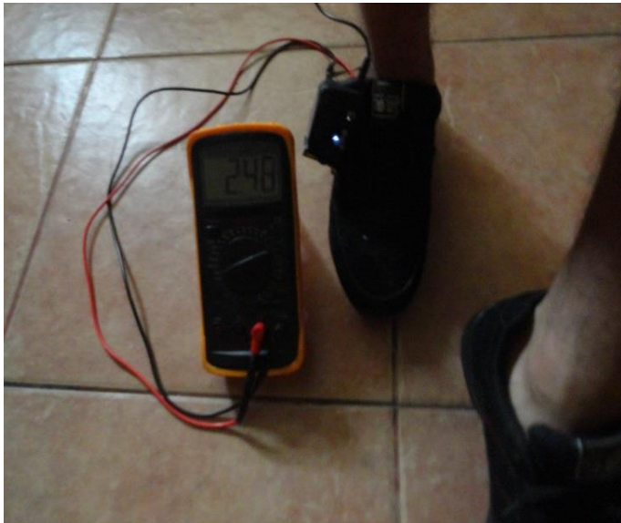
Fig. 31. Vista general del equipamiento utilizado para evaluar el desempeño de las plantillas piezoeléctricas alimentando un único LED. Fotografía tomada por los autores
