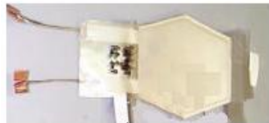
Fig. 3. Plantilla PVDF en forma de pentágono
