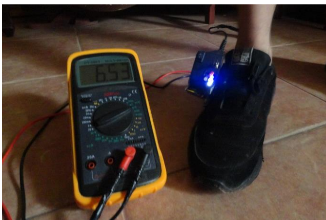
Fig. 34. Vista general del equipamiento utilizado para evaluar el desempeño del tercer prototipo de plantilla piezoeléctrica, alimentando una carga de 3 LEDs conectados en serie. Fotografía tomada por los autores
