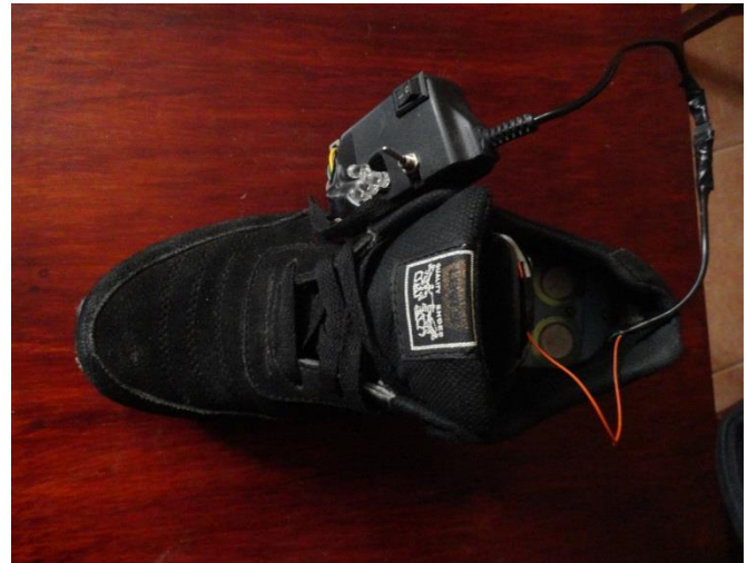
Fig. 26. Integración de las plantillas piezoeléctricas, y, circuito de harvesting y storage. Fotografía de los autores.
