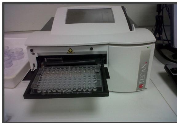
**Fotografía 6.** Espectrofotómetro para placa con pocillos
