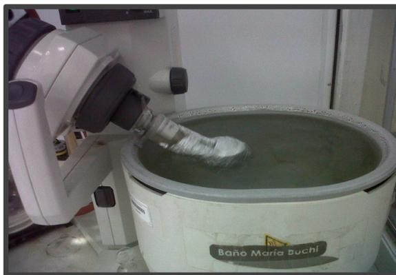
**Fotografía 4.** Eliminación del solvente por evaporación al vacío
