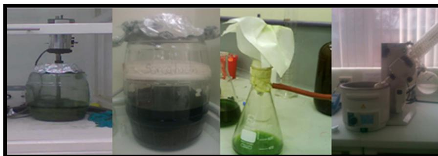
**Figura 5.** Obtención del extracto **a.** Maceración Dinamica **b.** Maceración Estacionaria **c.** Filtración al vacío **d.** Rotaevaporación.
