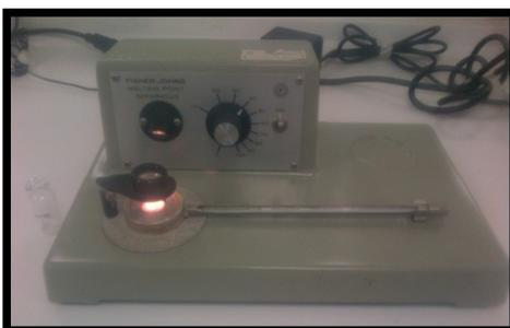
**Figura 9.** Equipo de fusión Fisher-Johns-Melting Point Apparatus serial 40-22.
