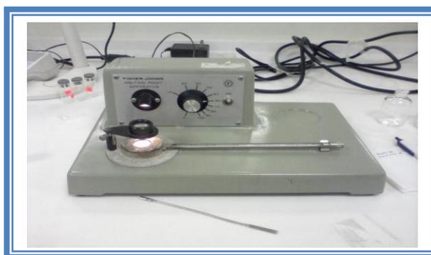
**Figura 9.** Equipo de fusión Fisher-Johns- Melting Point Apparatus serial 40-22.
