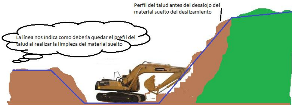
Figura 31: Limpieza del talud para colocar geosintético
