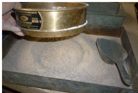
Fig. 4.4 Obtención de arenas mediante tamizado
