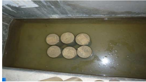
Fig. 6.3 Curado de especímenes de hormigón por inmersión
