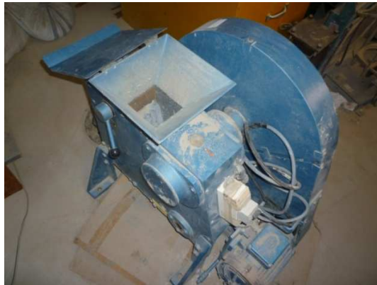
Fig. 4.3 Máquina trituradora de mandíbulas, perteneciente a la escuela de Ingeniería Civil, Geología y Minas
