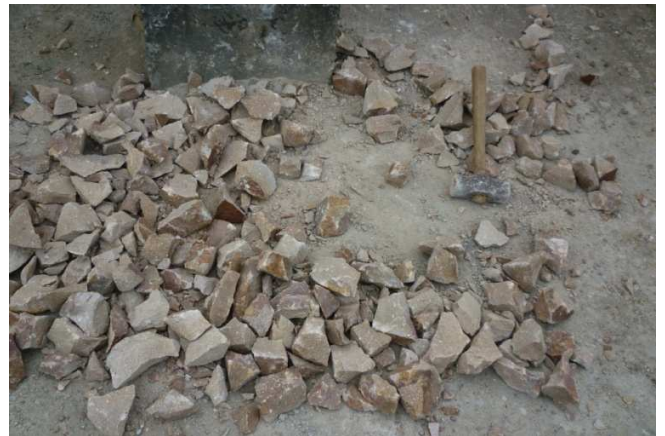
Fig. 4.2 Trituración manual primaria bloques pétreos
