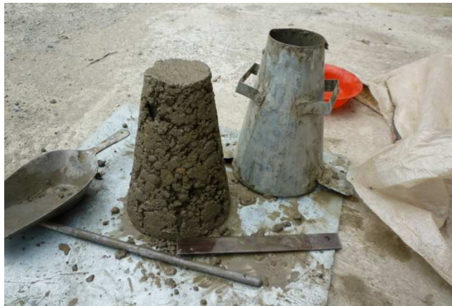
Fig 6.2 Ensayo de Asentamiento
