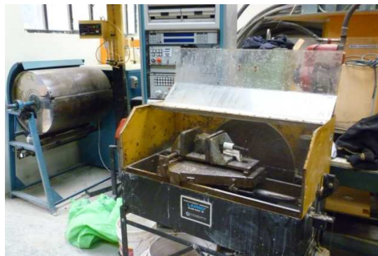
Fig 5.1 Cortadora de rocas para obtener cubos de 5cm de lado
