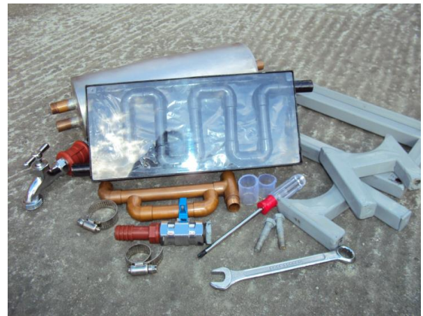
Fig. 21. Bloques del termosifón construido. Fotografía de los autores
