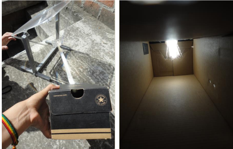
Figura 6.33. Funcionamiento del sistema de iluminación natural. Fuente: fotografía de los autores
