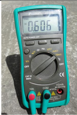
Figura 6.3. Configuración del multímetro en modo amperímetro.
