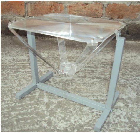
Fig. 28. Ensamblado final del sistema de iluminación natural. Fotografía de los autores.
