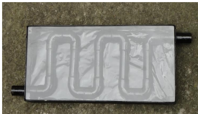
Figura 5.3. Colector solar. Fuente: fotografía de los autores
