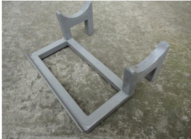
Figura 5.5. Estructura de soporte para el termosifón.
