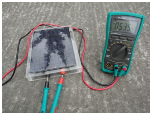
Figura 6.4. Esquema de medición de la corriente de corto circuito de un panel solar.
