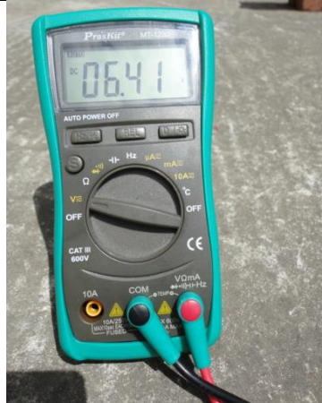
Figura 6.5. Configuración del multímetro en modo voltímetro. Fuente: fotografía de los autores
