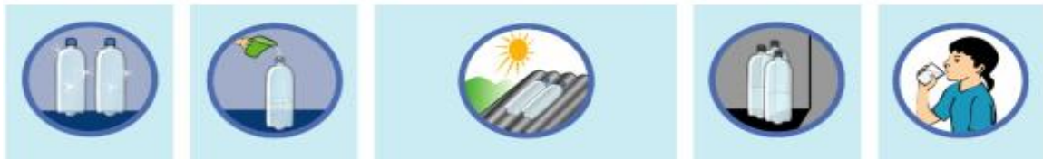
Figura 3.64. Proceso de purificación del agua con radiación UV.
