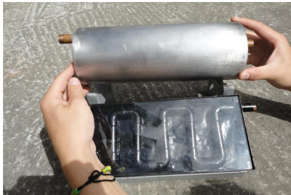
Figura 6.23. Ubicación del tanque de almacenamiento en el soporte.
