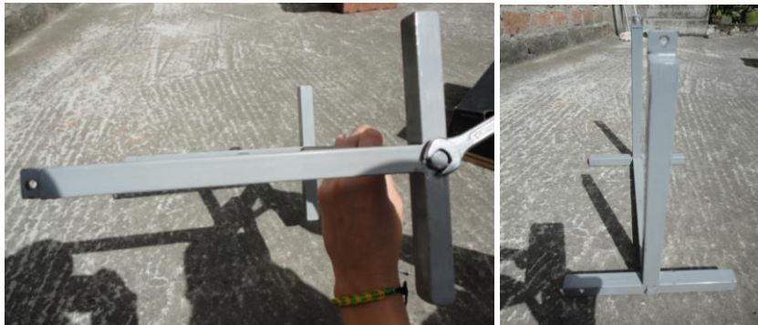
Figura 6.31. Armado del soporte metálico. Fuente: fotografía de los autores
