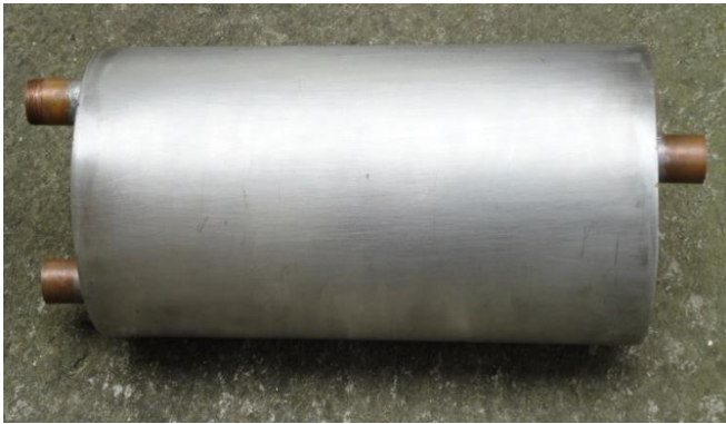
Fig. 23. Tanque de almacenamiento. Fotografía de los autores
