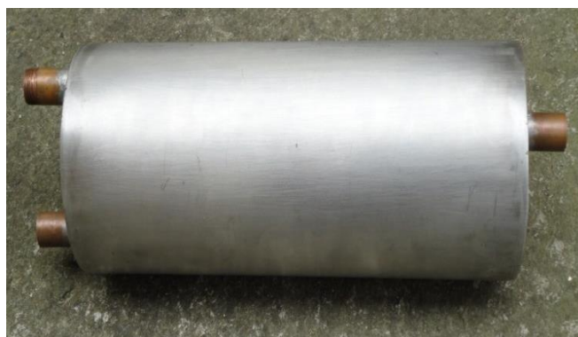
Figura 5.4. Tanque de almacenamiento. Fuente: fotografía de los autores
