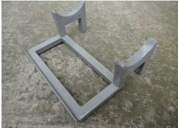
Fig. 24. Estructura de soporte para el termosifón. Fotografía de los autores
