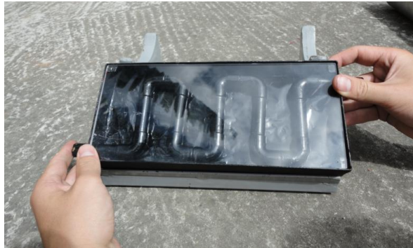
Figura 6.22. Ubicación del colector solar en el soporte.
