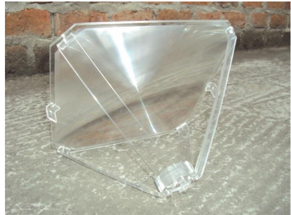
Fig. 27. Concentrador solar basado en una lente de Fresnel. Fotografía de los autores
