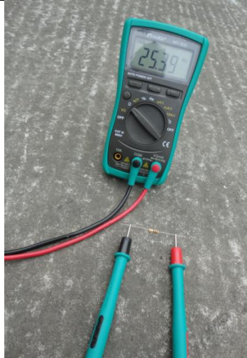
Figura 6.14. Esquema de medición de la resistencia. Fuente: fotografía de los autores
