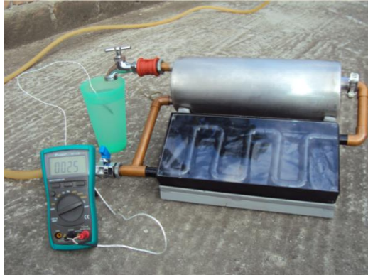
Figura 6.27. Medición de la temperatura de agua.
