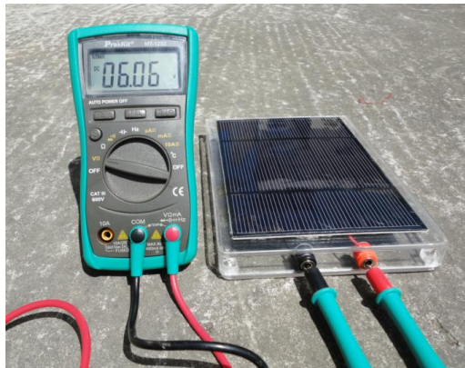
Figura 6.6. Esquema de medición del voltaje de circuito abierto de un panel solar. Fuente: fotografía de los autores
