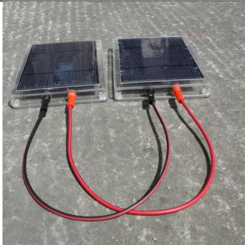
Figura 6.10. Conexión en paralelo de 2 paneles solares. Fuente: fotografía de los autores
