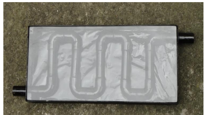
Fig. 22. Colector solar. Fotografía de los autores
