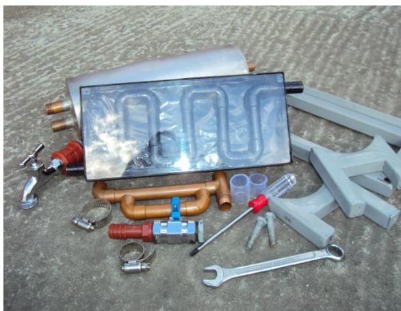
Figura 5.2. Bloques del termosifón construido.
