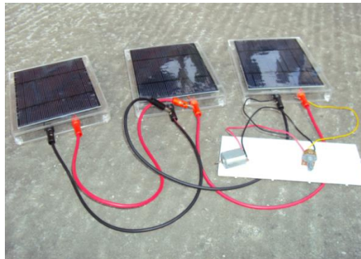
Figura 6.20. Conexión del motor DC a tres paneles solares, y, regulado por un potenciómetro. Fuente: fotografía de los autores
