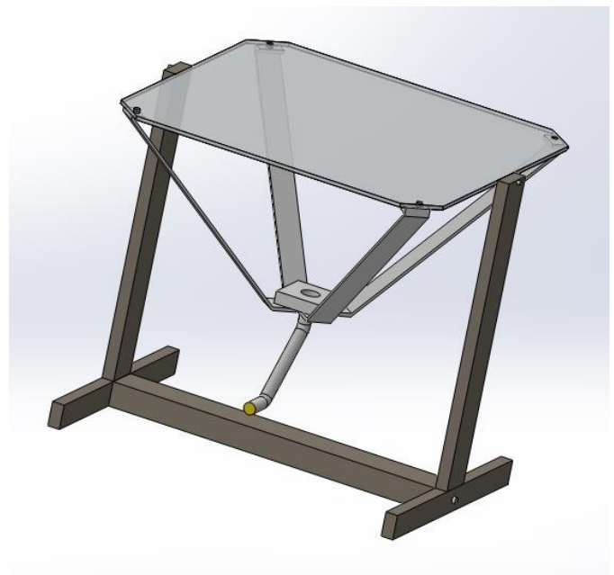
Fig. 15. Diseño general del concentrador para iluminación solar. Diseño de los autores
