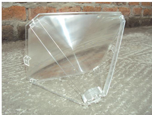
Figura 5.8. Concentrador solar basado en una lente de Fresnel. Fuente: fotografía de los autores
