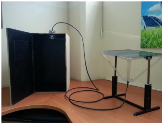
Figura 3.52. Sistema de concentración solar para iluminación solar. Fuente: diseño de Cristian León, Juan Veintimilla, Jorge Luis Jaramillo
