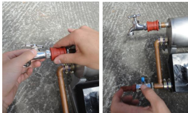
Figura 6.26. Ubicación de las llaves en el termosifón.
