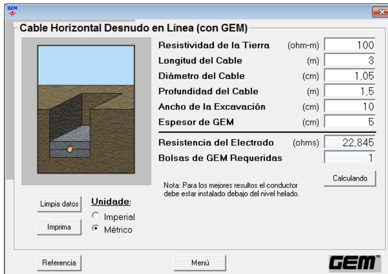
**Figura 1.35.** Cantidad de bolsas requeridas para cable horizontal.
