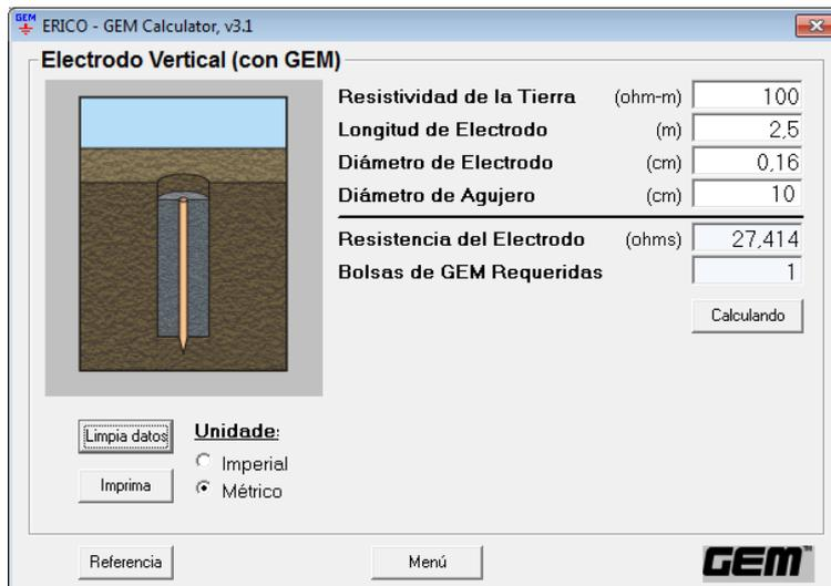
**Figura 1.34.** Cantidad de bolsas de GEM requeridas para electrodos verticales.
