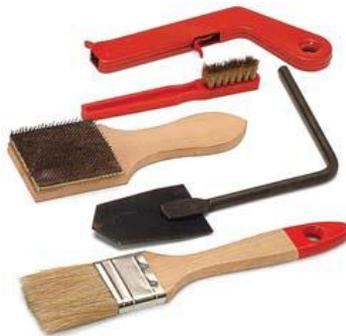
**Figura 1.45.** Materiales complementarios de la soldadura exotérmica.
